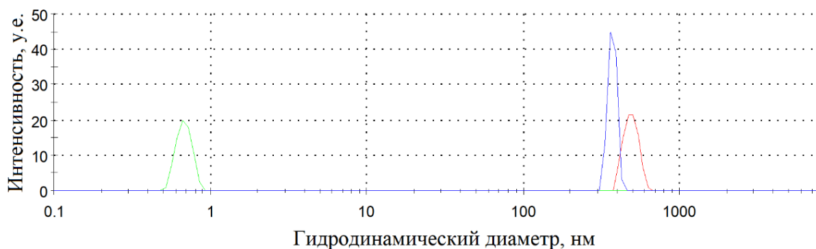
Рисунок 4.10. Распределения по размерам в растворах лизина (20 мг/мл) при pH 3 [552]: до фильтрации (—), сразу после фильтрации (—) и через 3 часа после фильтрации (—).
