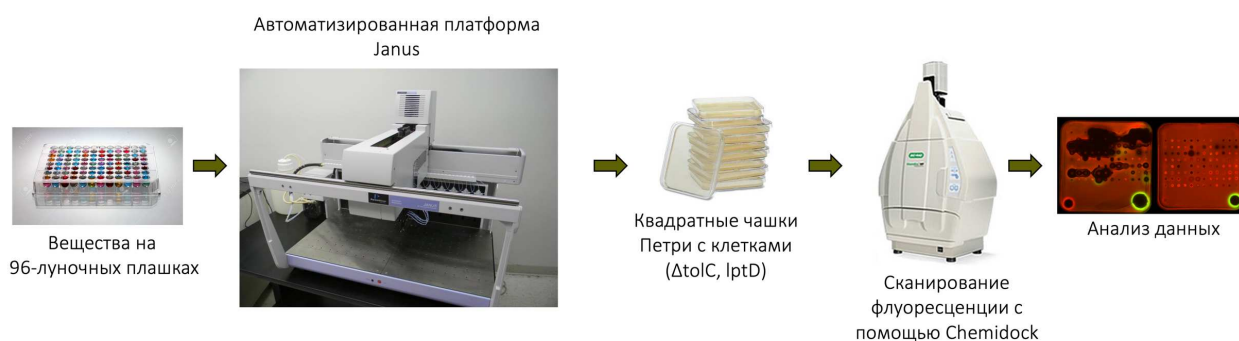
Рис. 25. Алгоритм поиска веществ с антибиотической активностью при помощи роботизированной станции “Janus”.
