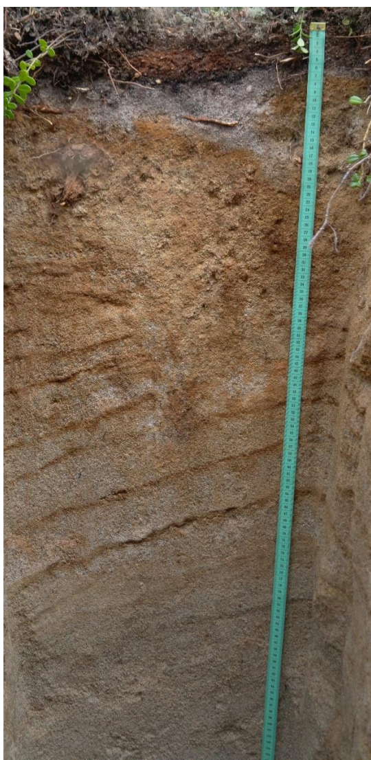
Рис 6. А — подзол иллювиально-железистый псевдофибровый мелкоподзолистый песчаный на морене, площадка П-1; Б — подзол иллювиально-железистый карликовый мелкоподзолистый песчаный на морене, площадка П-3.
