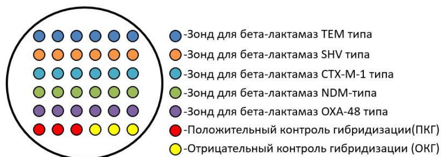
Рис. 4. Схема расположения специфичных и контрольных олигонуклеотидных зондов на биочипе в лунке 96-луночного планшета. На биочипе иммобилизованы специфичные олигонуклеотидные зонды для идентификации БЛ TEM-, SHV-, CTX-M-типа (класс А), NDM-типа (класс В), OXA-48 типа (класс D) и два контрольных зонда (положительный и отрицательный контроли гибридизации), последовательности которых не встречаются у бактерий.
