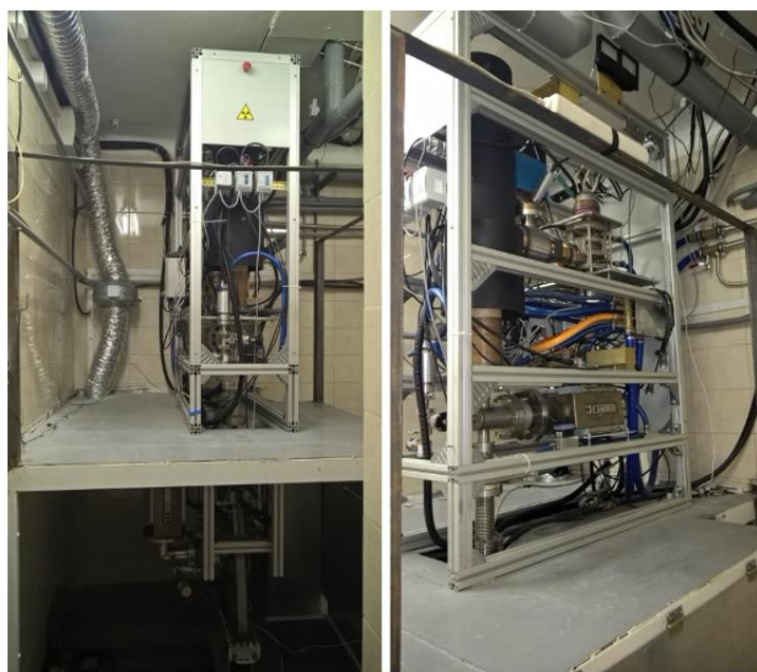
Рис. 20. Снимок и схема используемого ускорителя электронов. 1 – электронная пушка; 2 – клистрон; 3 – магнитный экран; 4 – ускоряющая структура; 5, 7, 11 – магниторазрядные насосы; 6 – магнит развертки; 8 – камера развертки; 9 – система СВЧ питания низкой мощности; 10 – охлаждаемая камера откачки; 12 – вакуумный затвор
