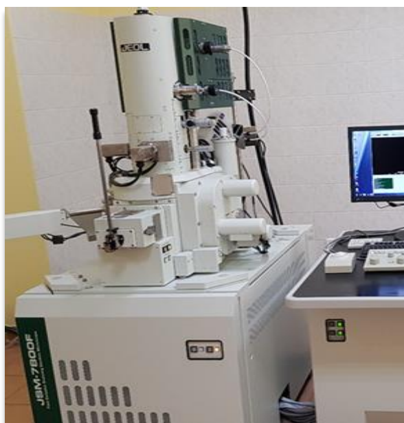
Рис. 17. Микроскоп JSM-7800 F от компании JEOL, СВФУ «Графеновые нанотехнологии» [27, 121, 122]
