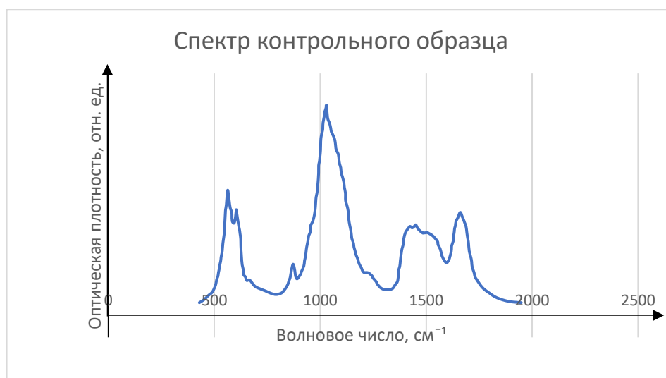
Рис. 32. Спектр поглощения контрольного образца на ИК-спектрометре.
