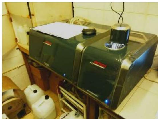
Рисунок 3.5. Лазерный гранулометр Fritsch Analysette 22 (фото Н.А. Тюнина, 2017)
