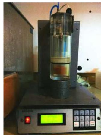
Рисунок 3.6. Карбонатометр КМ-04М (фото Н.А. Тюнина, 2017)
