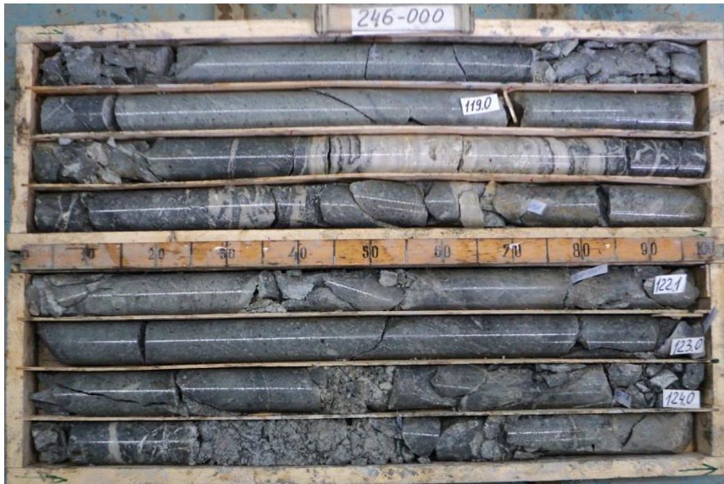
Рис. 60. Макроскопические изменения околорудных игнимбритов риодацитов вархаламской толщи в керне скважин месторождения Невенрекан.
