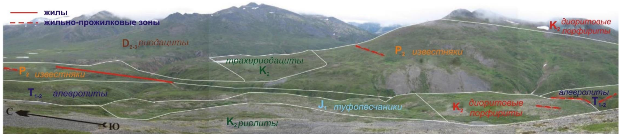
Рис. 26. Панорамный вид на южную часть рудопроявление Желты; участки развития жильных зон. Направление фотосъёмки на рис. 24. (фотография А.Н. Глухова).
