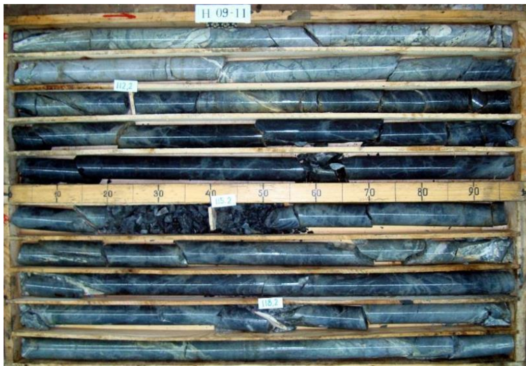
Рис. 37. Керн скважин с рудными пересечениями месторождения Пережатное (диаметр NQ – 47.6 мм).
