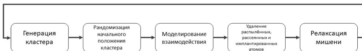
Рисунок 3.11. Схема последовательных МД расчётов.
