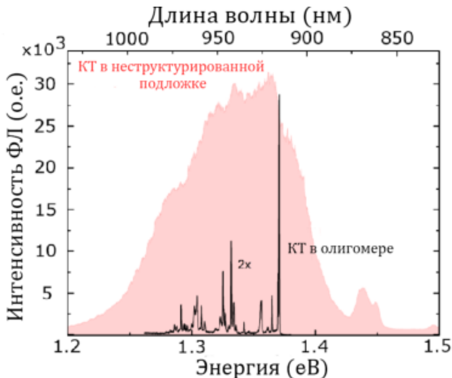
Рис. 77: Красная область - спектр \mu -ФЛ квантовых точек InAs, внедренных в пленку GaAs, полученный с использованием пучка накачки диаметром 2,5 мкм и длиной волны 404 нм. Черная кривая - типичный спектр квантовых точек InAs, расположенных в объеме нанодисков GaAs изолированного квадрумера.
