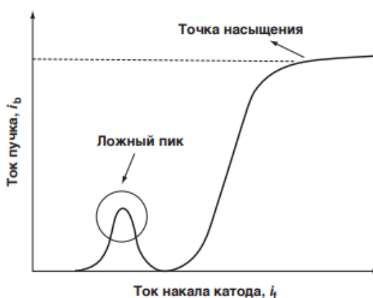
Рисунок 1.8. Ток насыщения электронной пушки с вольфрамовым V-образным катодом: в точке насыщения большинство электронов эмитируется с острия катода, при этом под влиянием ускоряющего напряжения формируется плотный электронный пучок.
