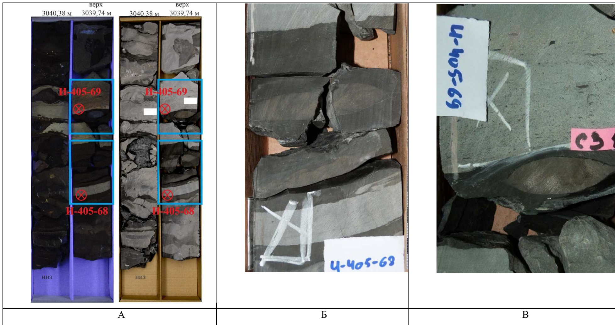
Рисунок 23. Фото керн в верхней части баженовско-ачимовского комплекса скв. 405 Имилорской (АР): А) общий вид в ультрафиолетовом (слева) и дневном (справа) свете с отмеченными местами отбора образцов для изготовления шлифов (красный круг) и с отмеченными голубыми рамками интервалами для укрупненных фрагментов на Б и В, Б) укрупненный фрагмент с показанным местом отбора образца И-405-68 (белый крест), В) укрупненный фрагмент с показанным местом отбора образца И-405-69 (белый крест)
