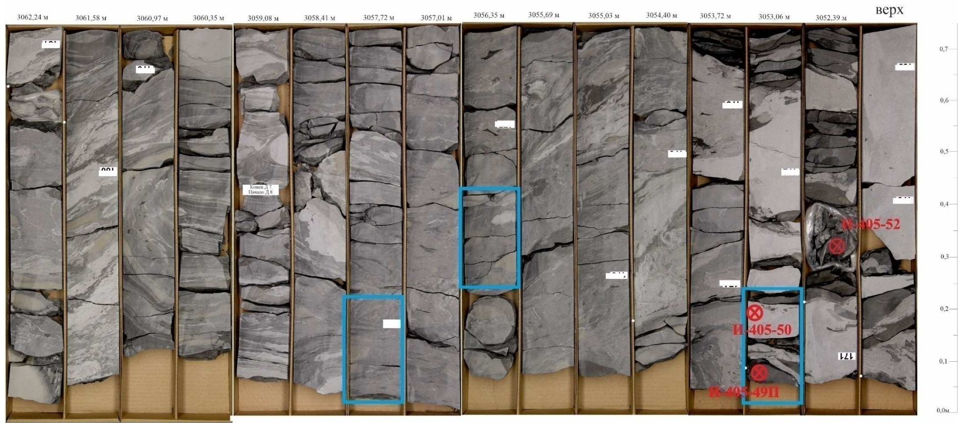
Рисунок 28. Фото керна в центральной части АР баженовско-ачимовского комплекса скв. 405 Имлорской с отмеченными местами отбора образцов для детального изучения в шлифах (красный круг), голубыми рамками показаны фрагменты, данные более крупно на Рисунок 29
