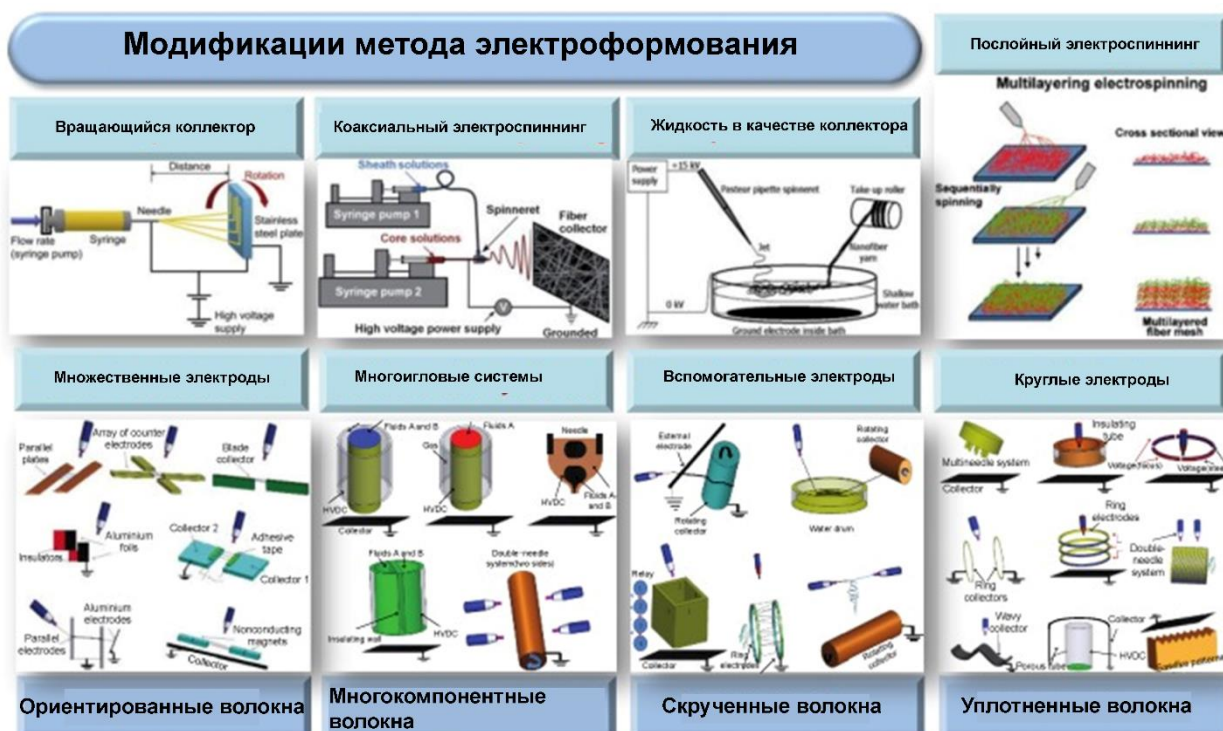
Рисунок 9 – Различные модификации метода электроспиннинга [210]
