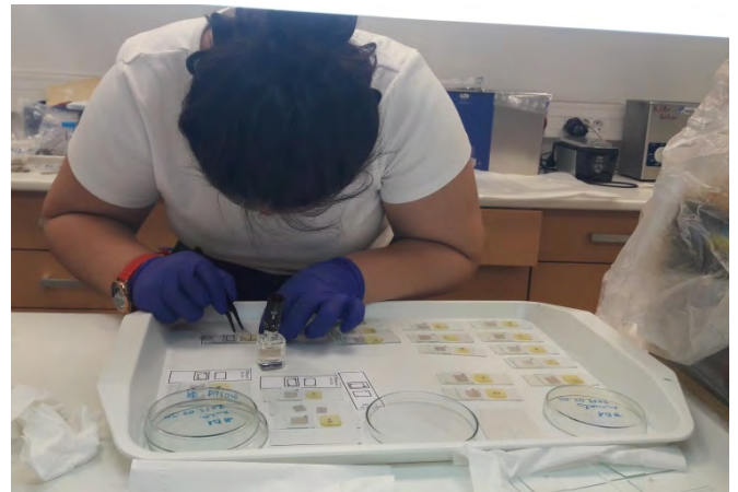
Рисунок 17. Процедура пробоподготовки для трекового датирования методом внешнего детектора. (а) Готовый препарат для трекового датирования методом внешнего детектора: слева – монофракция апатита в эпоксидной смоле, справа – внешний детектор мусковит. (б) Подготовка проб для трекового датирования методом внешнего детектора в трековой лаборатории Института ядерной физики (Венгрия, г. Дебрецен).
