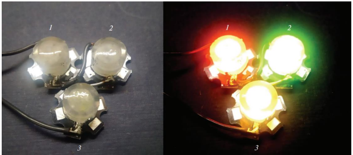
Рис 37. Макеты излучателей, созданных с применением промышленных УФ-LED-источников и кристаллов \text{La}_{0.58}\text{Eu}_{0.42}\text{MgB}_5\text{O}_{10} (1), \text{La}_{0.29}\text{Tb}_{0.71}\text{MgB}_5\text{O}_{10} (2), \text{La}_{0.19}\text{Eu}_{0.04}\text{Tb}_{0.77}\text{MgB}_5\text{O}_{10} (3).
