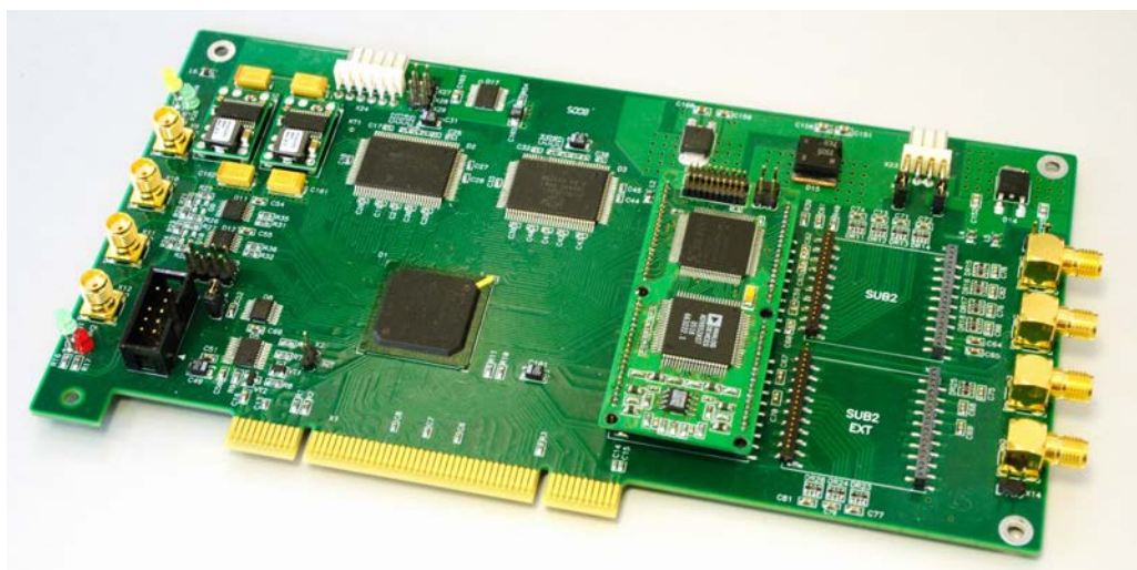
Рис. 3.3. Двухканальный генератор сигналов произвольной формы типа VCO разработки НИТУ МИСИС.
