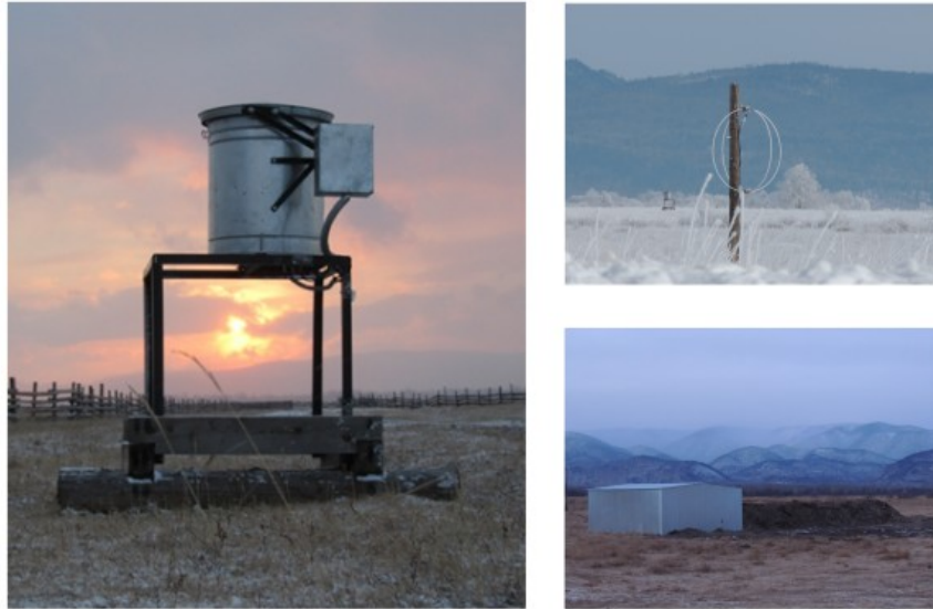
Рисунок 1.7 — Внешний вид оптического детектора установки Тунка-133 (слева), антенны установки Tunka-Rex (справа сверху) и станции установки Tunka-Grande (справа снизу).
