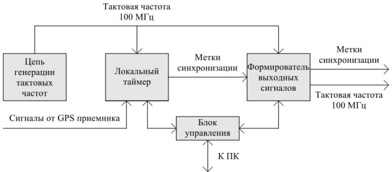
Рисунок 2.14 — Структурная схема МегаХоста.
