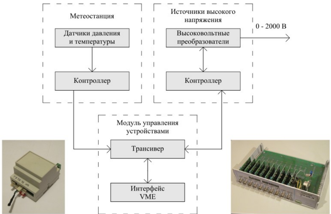
Рисунок 2.12 — Структурные схемы модуля управления устройствами, 10-канального источника высокого напряжения, метеостанции, взаимосвязь между ними и их изображения.
