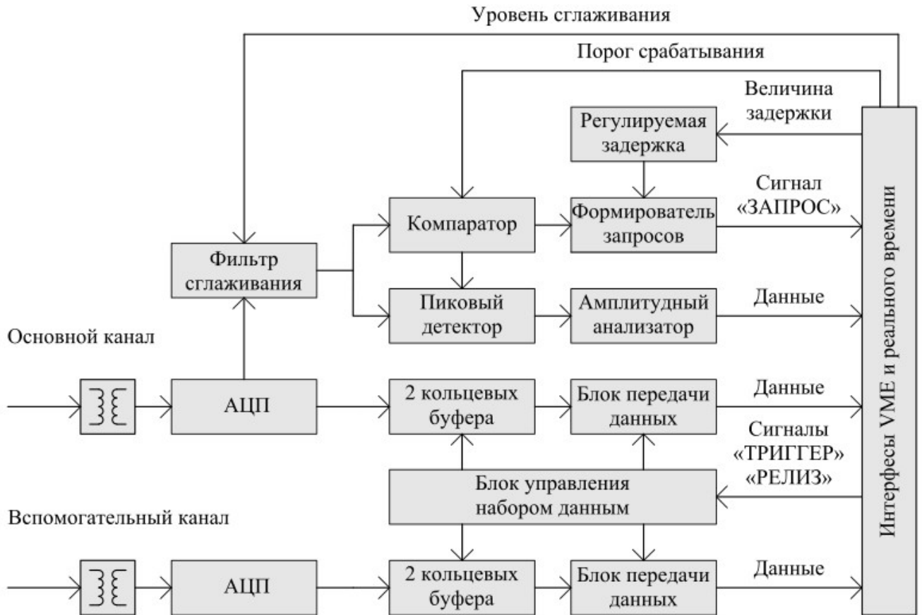
Рисунок 2.10 — Структурная схема модуля измерения формы сигналов.
