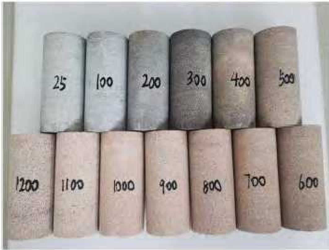
Рисунок А.98. Образец песчаника после воздействия высоких температур (по: [Zheng et al., 2024, fig. 1, d])
