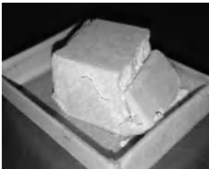
Рисунок 5.1 – Фотография образца МКФ-САО компаунда после определения прочности на сжатие при исследовании устойчивости к термическим циклам [5]
