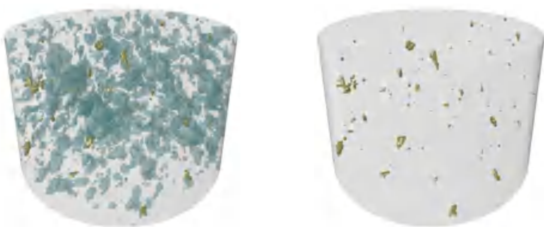
Рисунок 3.12 – 3D-модели фазового распределения пор и La-содержащей фазы в объеме цилиндрического МКФ-La компаунда диаметром 10 мм: исходного образца (а) и образца после выщелачивания (б)
