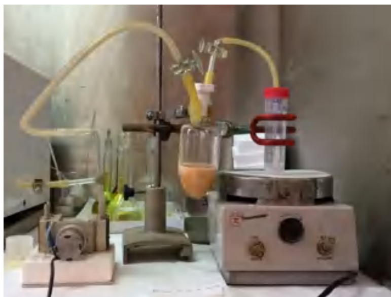
Рисунок 2.12 – Установка для контроля выделения аммиака при отверждении имитатора САО в МКФ компаунде
