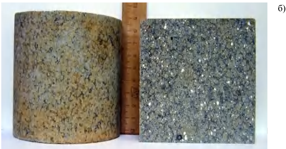
Рисунок 4.4 – Фотографии полученных МКФ компаундов объемом около 1 л с иммобилизованными имитаторами высокоактивного (а) щелочного декантата и (б) шлама [183]
