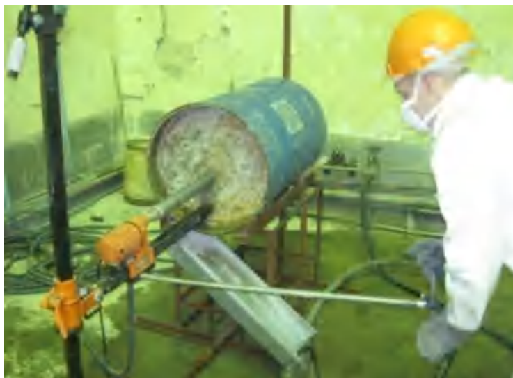
Рисунок 7.5 – Отбор проб образцов МКФ компаунда с включениями и без включений ила [230]
