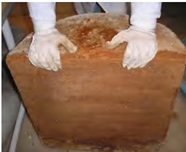
Рисунок 7.4 – Отверждение имитатора среднеактивной пульпы гидроксида железа(III) (без радионуклидов) в объеме 200 л [176]
