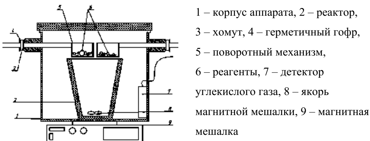
Рисунок 2.15 – Схема установки для определения \text{CO}_2 при синтезе образцов МКФ компаунда, содержащего \text{CaCO}_3 [110]
