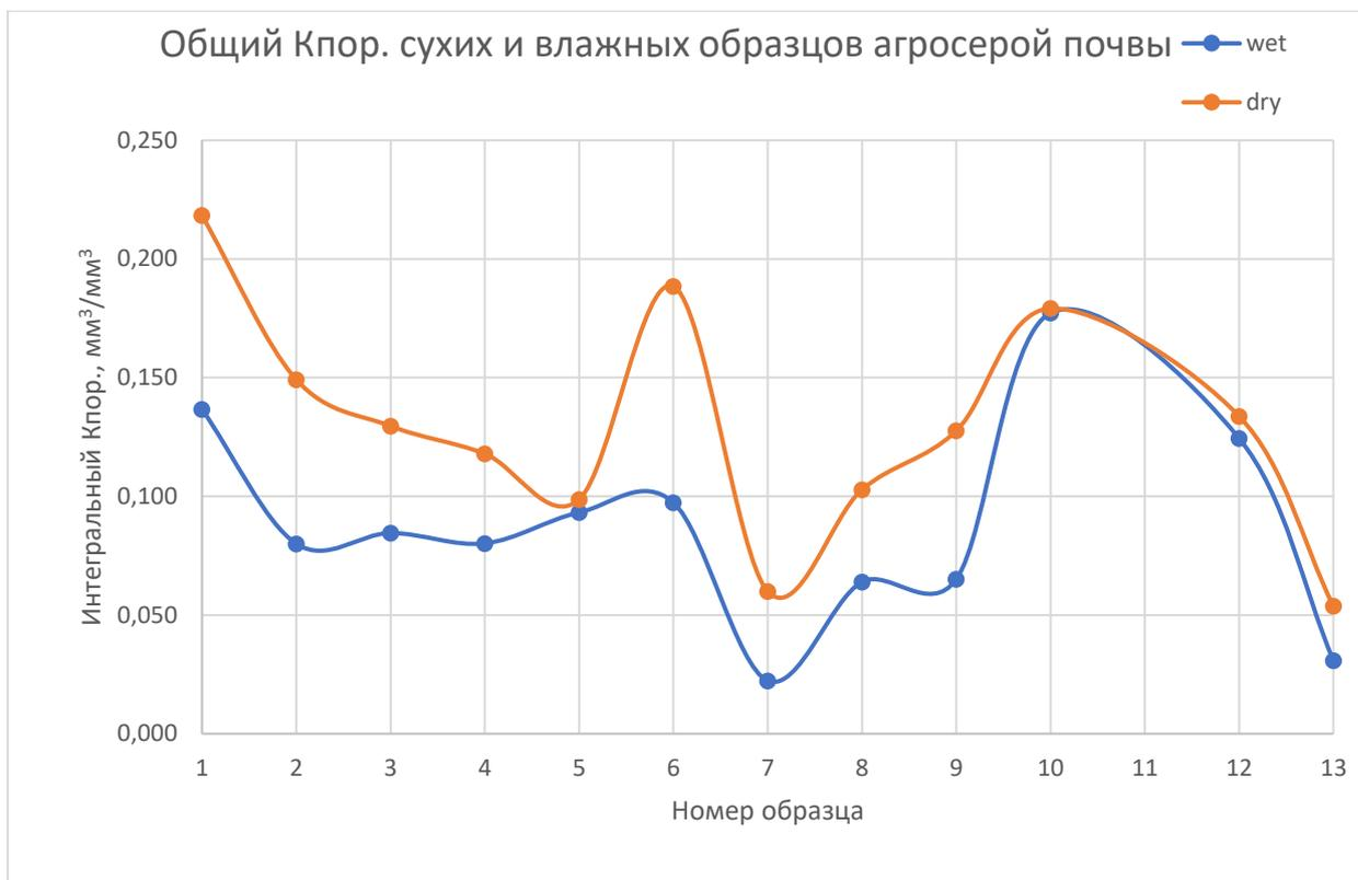
Рисунок 23. Общий коэффициент пористости  $V_{пор}/V_{тв.фазы}$  сухих и влажных образцов агросерой почвы
