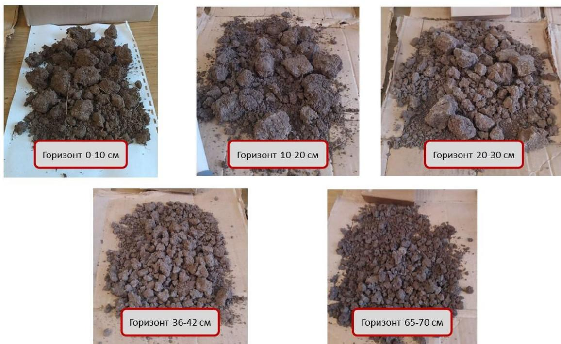
Рис. 6. Фотография используемых для анализа образцов дерново-аллювиальной глееватой почвы с характерной структурой горизонтов
