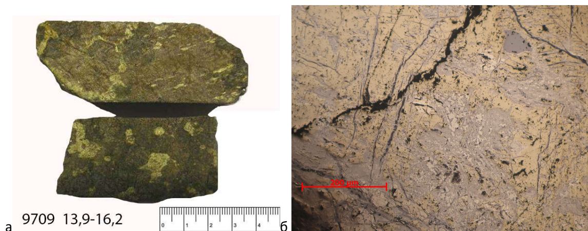
Рис. 3.11. Петельчатый и пластинчатый пирротин в халькопирите: а) – общий вид; б) в отраженном свете.
