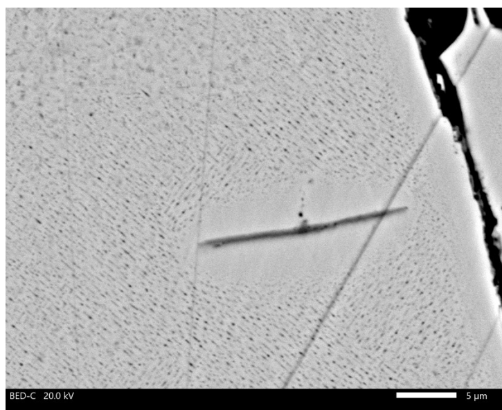
Рис.4.10. Решётка распада твёрдого раствора в зерне ильменита. Фото СЭМ в режиме отражённых электронов.
