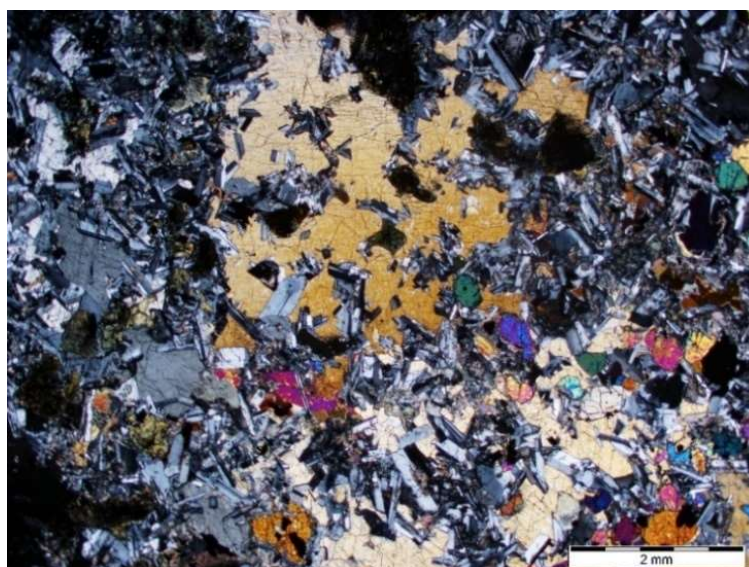
Рис. 4.2. Пойкилофитовая структура габбро-долерита. Изображение в проходящем свете, николи скрещены
