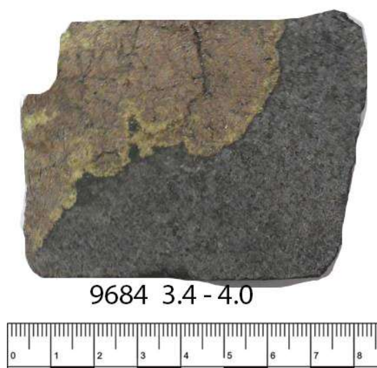
Рис. 3.10. Кайма халькопирита на границе кристалла пирротина и включения габбро-долерита
