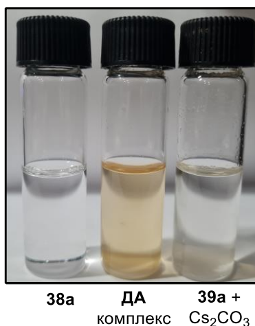
Рисунок. 3.11 Внешний вид растворов 4-бромацетофенона ( 38a ) в ДМСО, смеси реагентов 38a , 39a и \text{Cs}_2\text{CO}_3 (1:1:2) в ДМСО и смеси этилцианоацетата ( 39a ) и \text{Cs}_2\text{CO}_3 (1:2) в ДМСО.
