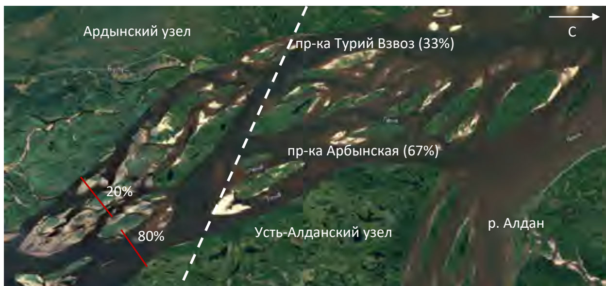
Рисунок 3.3.12– Схема рассредоточения стока в Арбынском и Усть-Алданском узлах
