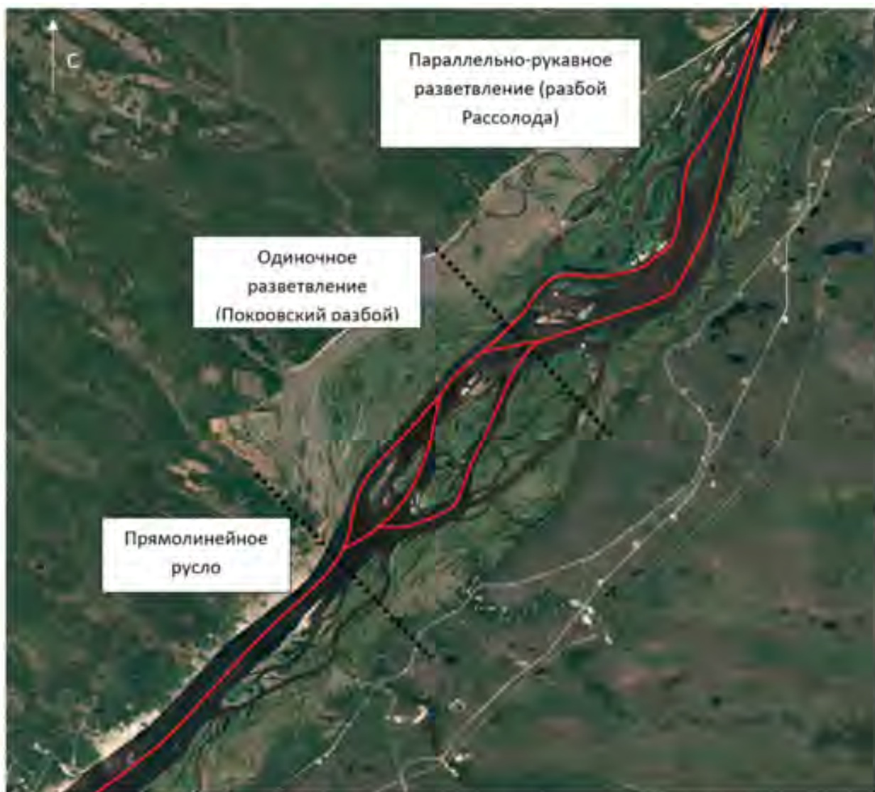
Рисунок 3.2.21 – Общая схема Покровского разбоя и разбоя Рассолода (красными линиями выделено положение динамических осей потока)
