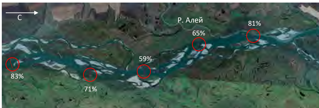
Рис. 3.3.3 - Схема распределения расходов воды на участке реки в районе устья р.Алей в условиях спада половодья по данным измерений 2016 г.
