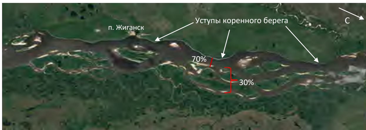
Рисунок 3.3.18 – Схема рассредоточения стока в Жиганском узле разветвления
