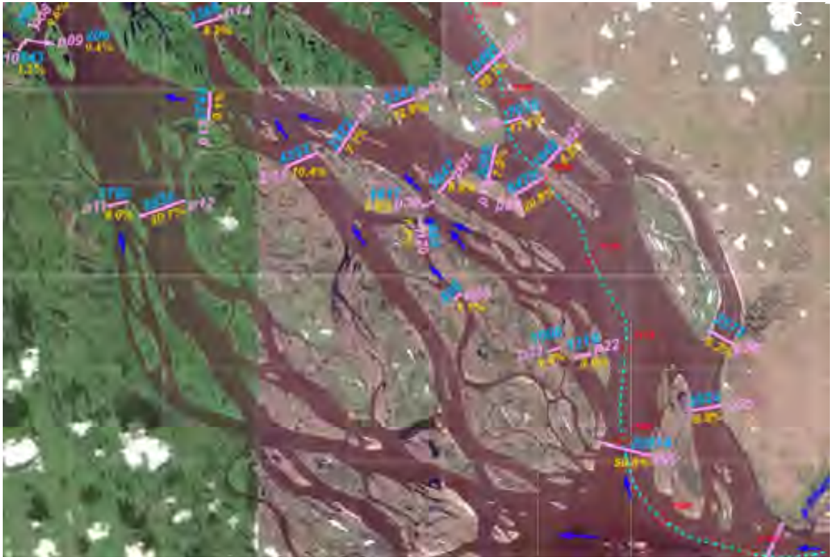
Рисунок 3.3.14 – Общая схема распределения расходов воды по рукавам узла Черпальский-Рысий (измерения 24-25 июня 2020 г)
