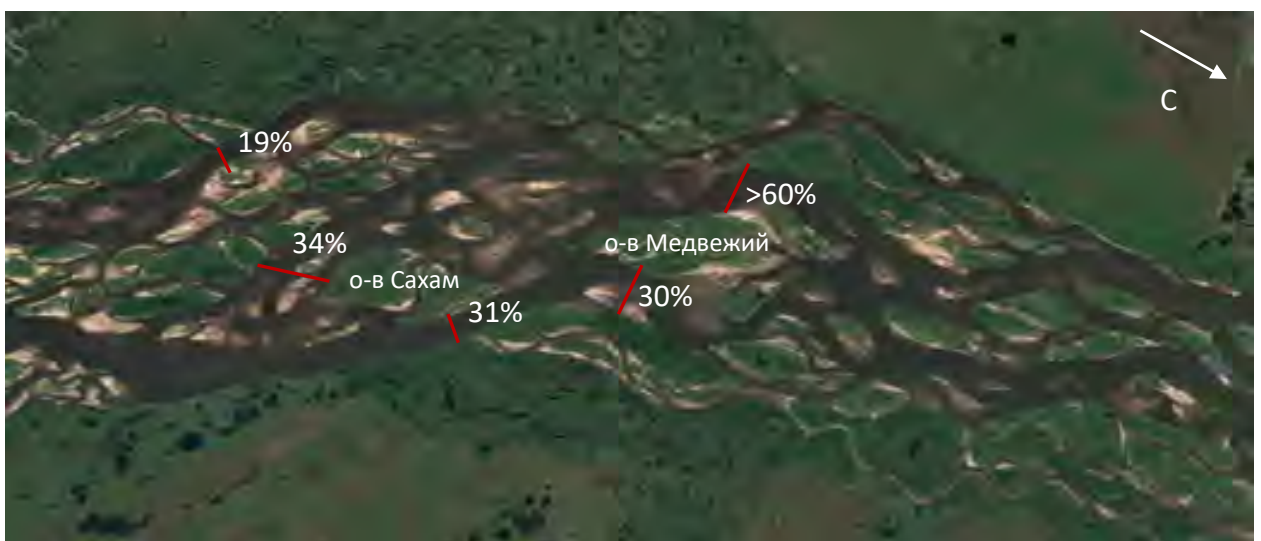
Рисунок 3.3.16 – Схема рассредоточения стока у о-в Медвежьего и Сахама по состоянию на июнь 2020 г.
