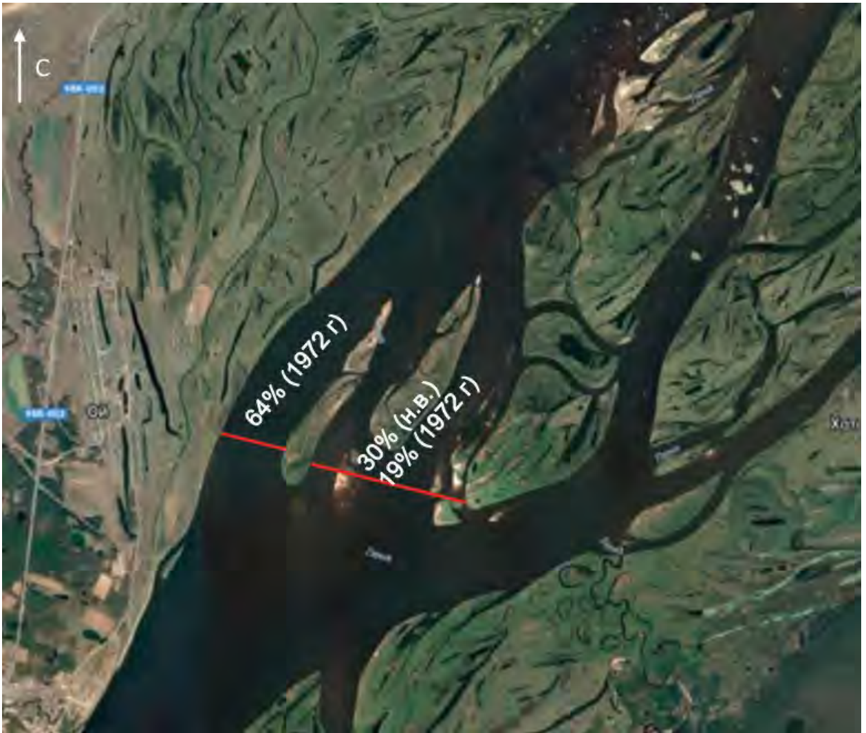
Рисунок 3.3.9 – Схема распределения расходов воды на покровском узле
