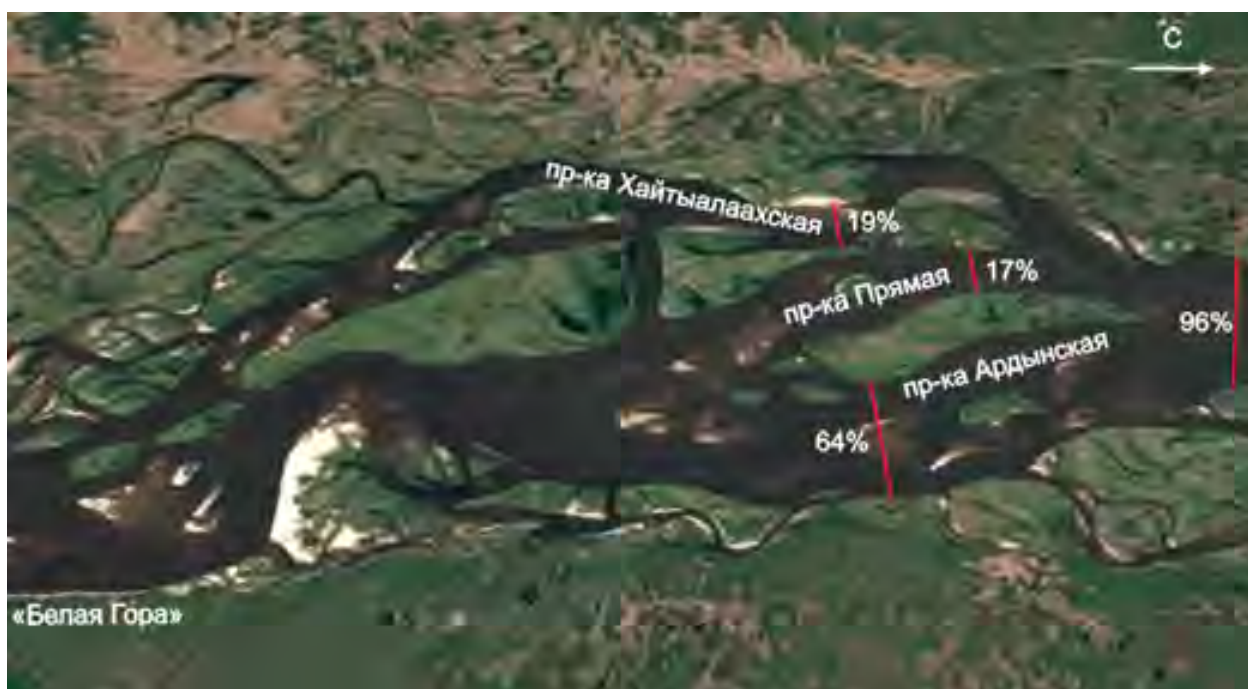
Рисунок 3.3.10 – Схема рассредоточения стока в Хайтылаахском узле
