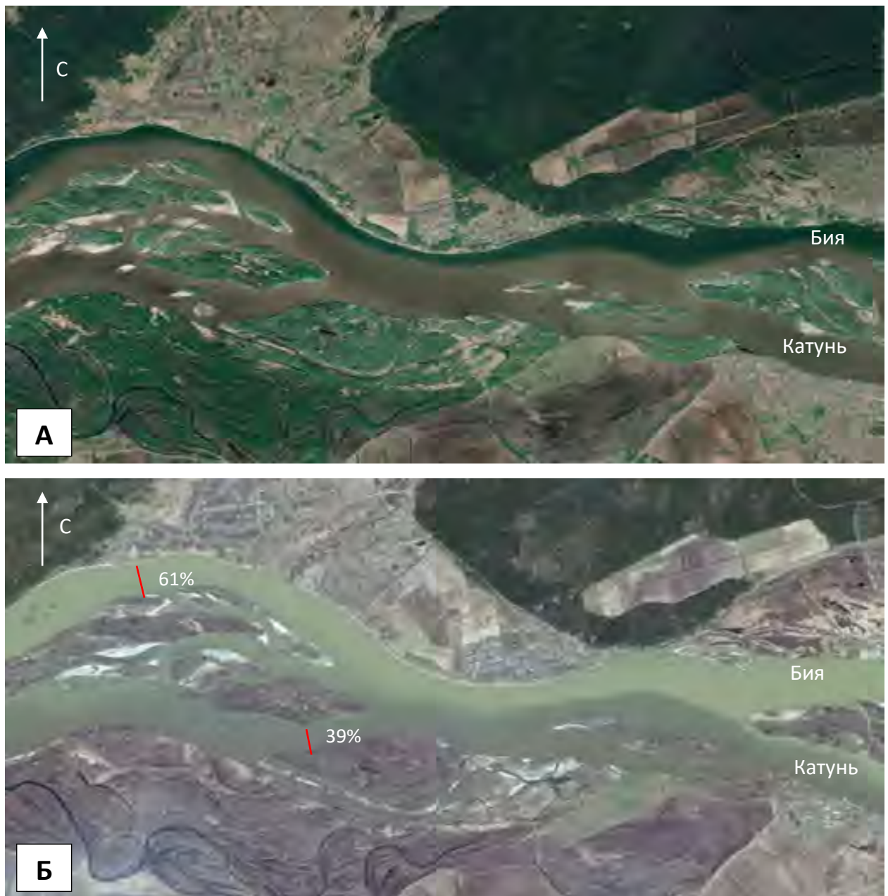
Рисунок 3.3.1 – Схема взаимодействия Бийского Катуньского потоков
