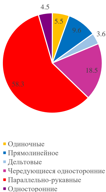
Рисунок 3.2.33 – Доли различных типов русла на Лене
