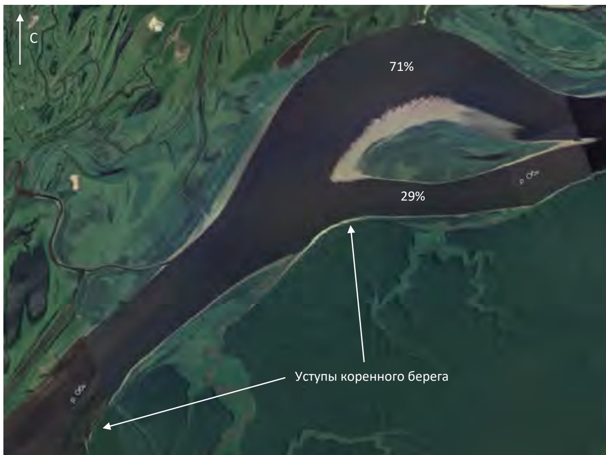
Рисунок 3.3.7 – Разветвление с концентрацией стока в левом рукаве, обусловленное отклоняющим воздействием уступов коренного берега
