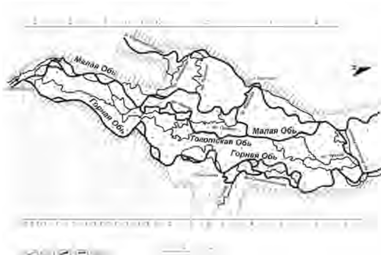
Рисунок 3.2.13 - Морфодинамические типы русла от с. Перегребного до протоки Большой Нюрик.
