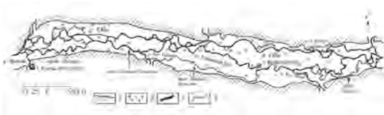
Рисунок 3.3.6 - Раздвоенное русло средней Оби (широтный участок от устья р. Вах до слияния с р. Иртыш). 1 – коренные берега; 2 – пойма; 3 – рукава раздвоенного русла; 4 – пойменные протоки и притоки [Чалов, Куракова, Камышев и др., 2022].
