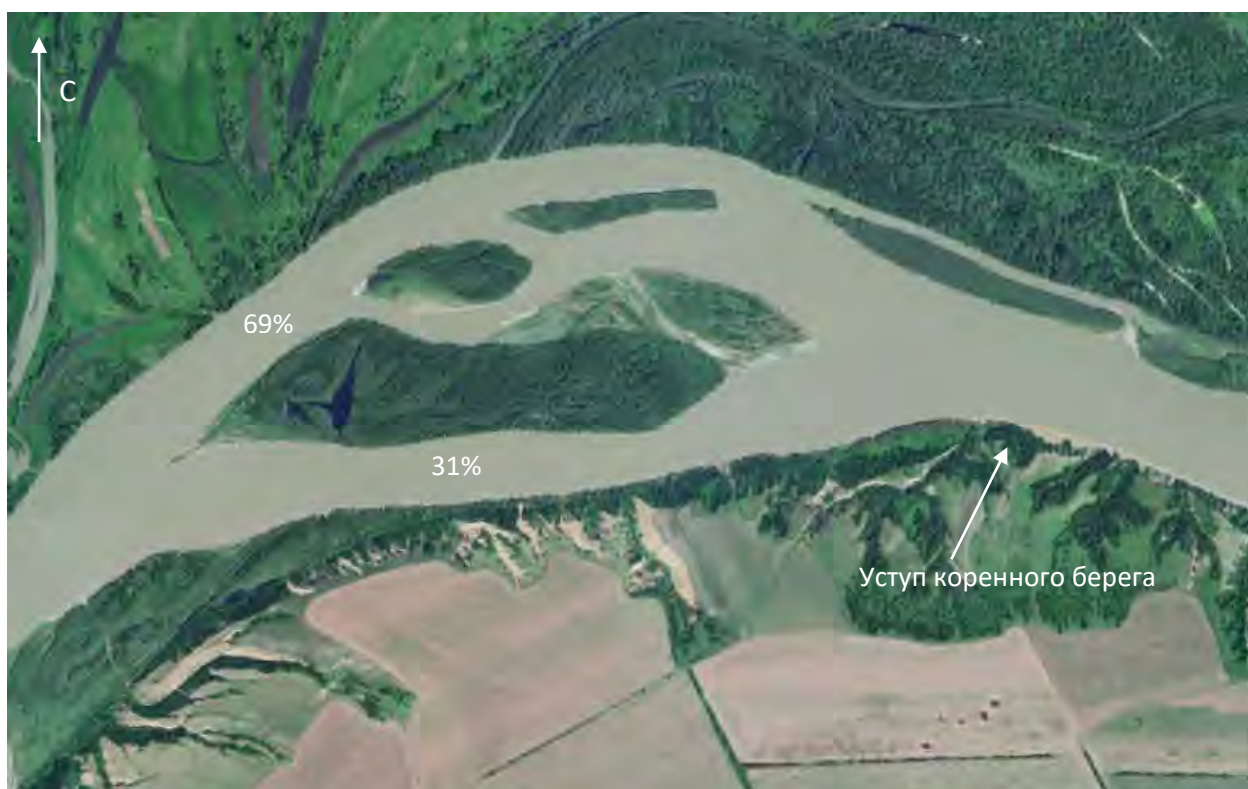
Рис. 3.3.5. Разветвления с концентрацией стока в правом рукаве, обусловленным отклоняющим воздействием уступов коренного берега
