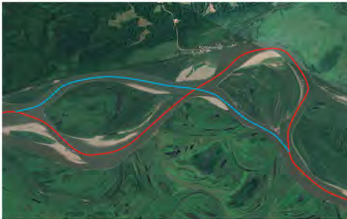
Рисунок 5.17 – Последовательное спрямление двух излучин (спрямляющие протоки выделены синим)
