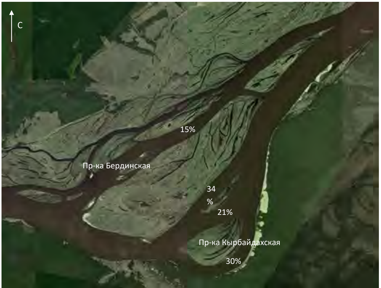
Рисунок 3.3.8 – Схема рассредоточения расходов воды в Кыллахском «разбое»
