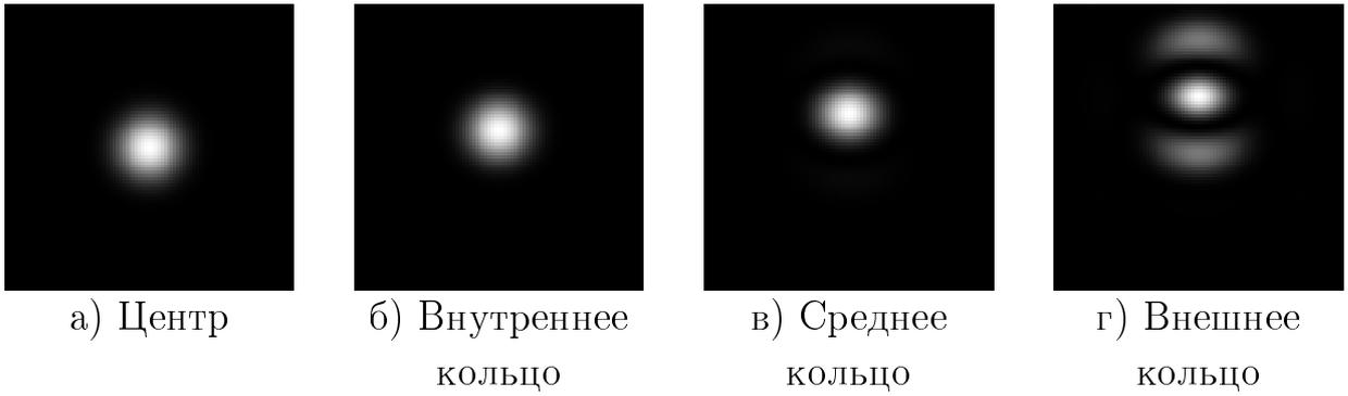
Рисунок 1.7 — Нормированные по яркости ядра размытия для элементов из разных слоёв детектора Airyscan
