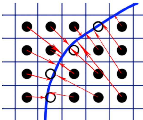
Рисунок 2.2 — Принцип работы деформационного метода повышения резкости изображений в двумерном случае: смещение пикселей окрестности контура (чёрные пиксели) по направлению к контуру (белые пиксели)
