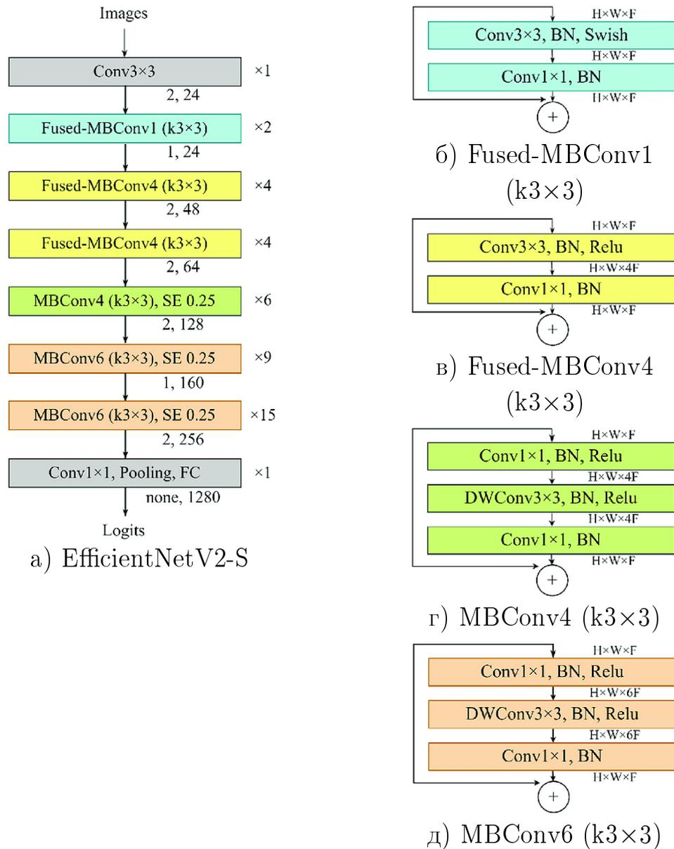
Рисунок 3.10 — Архитектура нейронной сети EfficientNetV2-S и её составных блоков [81]
