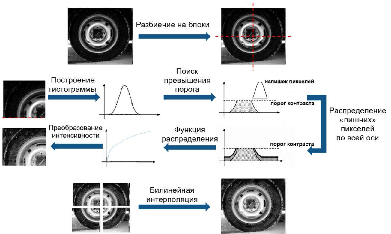
Рисунок 3.7 — Базовая схема алгоритма контрастно-ограниченной эквализации гистограммы CLANE
