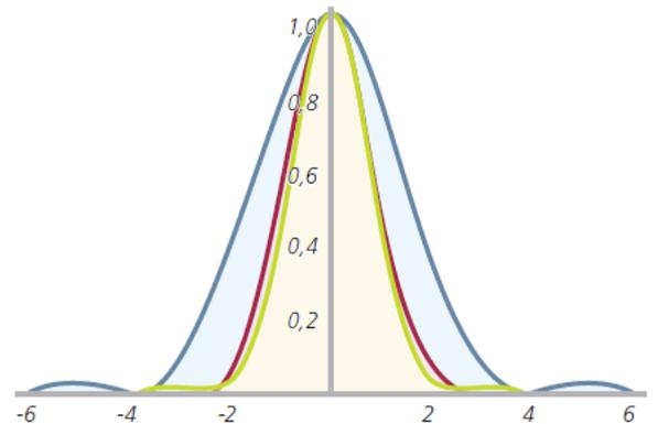
Рисунок 1.6 — Нормированные профили ядер размытия обычного широкопольного (синий), конфокального сканирующего (красный) микроскопов и микроскопа с детектором Airyscan (зелёный)
