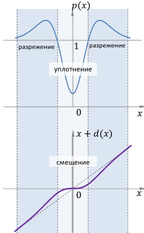
Рисунок 2.8 — Пример функции близости и результата смещения пикселей с её помощью
