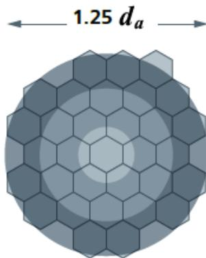
Рисунок 1.5 — Схема детектора Airyscan. Сенсоры расположены в центрах правильных шестиугольников
