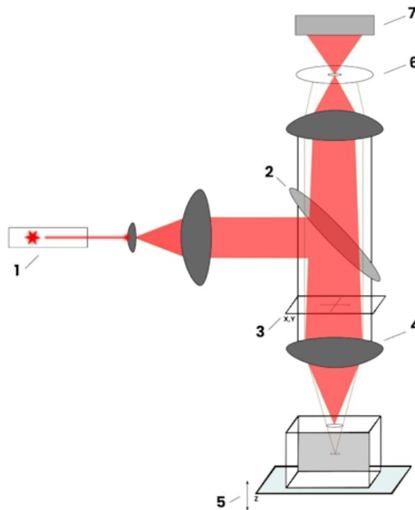
Рисунок 1.2 — Базовая схема конфокального лазерного сканирующего микроскопа. 1 — источник лазерного излучения; 2 — дихроичное зеркало, отражающее излучение с определённой длины волны; 3 — механизм управления направлением луча лазера; 4 — линза объектива; 5 — механизм управления расстоянием от объектива до образца; 6 — точечная диафрагма; 7 — детектор флуоресцентного излучения.
