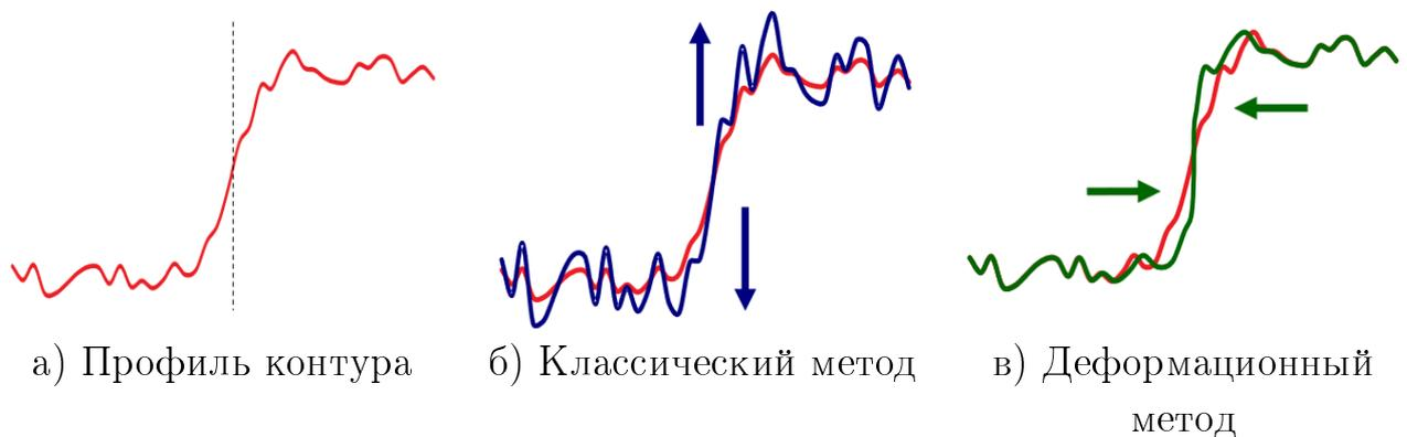
Рисунок 2.1 — Принцип работы классических методов и деформационного метода повышения резкости изображений в одномерном случае
