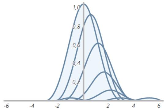
Рисунок 1.4 — Изменение профиля ядра размытия при смещении детектора излучаемого образцов света от оптической оси
