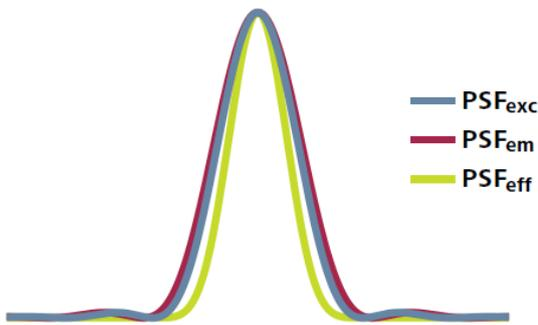
Рисунок 1.3 — Нормированные профили ядер размытия лазера подсветки ( $PSF_{exc}$ ), объектива ( $PSF_{em}$ ) и микроскопа ( $PSF_{eff}$ )
