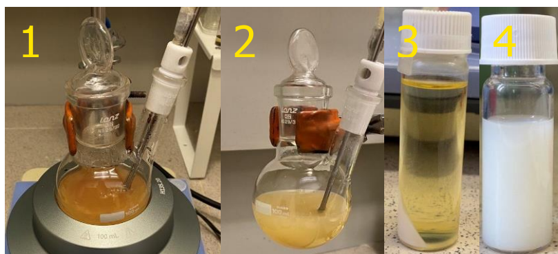
Рисунок 37. Фото раствора с нанопластинками после окончания реакции (1), очистка триоктилфосфином (2), очистка центрифугированием (3), раствор нанопластинок ZnSe 2,5 МС в гексане (4).
