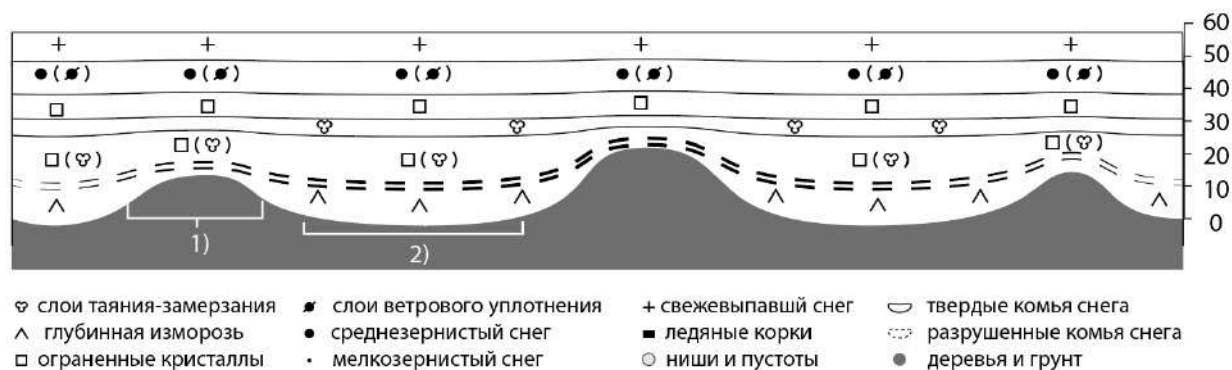
Рис. 3.3.4 Схема строения снежной толщи в траншее (5 м) на защищенной от ветра поляне в период максимальных снегозапасов 15 февраля 2021 года.
