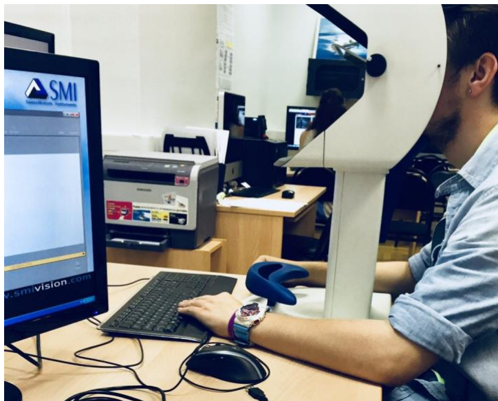
Рисунок 18 - Установка бесконтактной регистрации движений глаз SMI Hi-Speed
