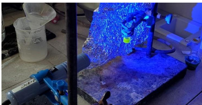
Рисунок 61. Фотография эксперимента по исследованию фотовысвобождения цисплатина из пролекарства Pt-22 под действием излучения 450 нм и структура пролекарства Pt(IV) Pt-22 .
