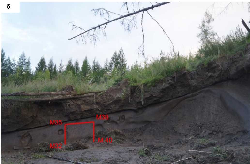
Рис. 4.15. Профили отбора образцов подземного льда на изотопный анализ. Нижний ярус подземного льда обнажения V террасы Мамонтовой горы: а – точка 2; б – точка 3.
