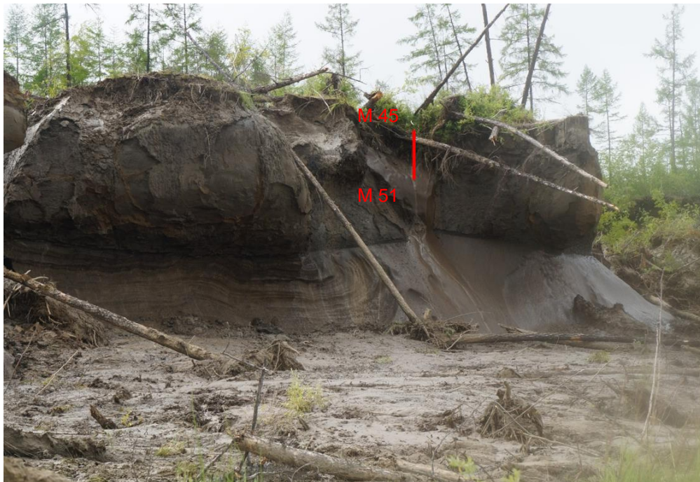
Рис. 4.16. Профили отбора образцов подземного льда на изотопный анализ. Верхний ярус подземного льда обнажения V террасы Мамонтовой горы: а – точка 5; б – точка 6.
