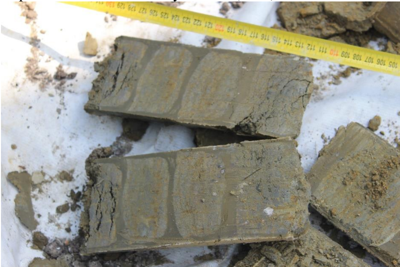
Песок мелкозернистый до пылеватого, массивной криотекстуры 13,8-15,0 м
