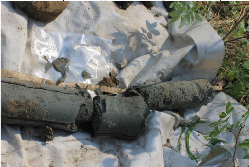
Песок мелкозернистый до пылеватого, массивной криотекстуры 13,8-15,0 м
