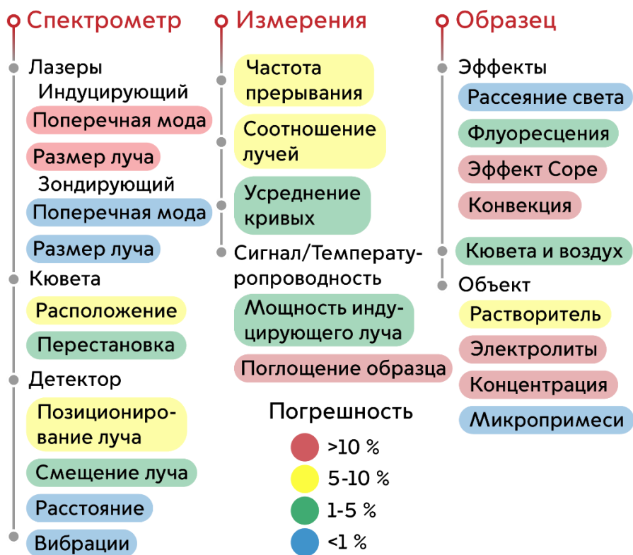
Рис. 3. Влияние источников систематической погрешности фототермических измерений светопоглощения и температуропроводности.
