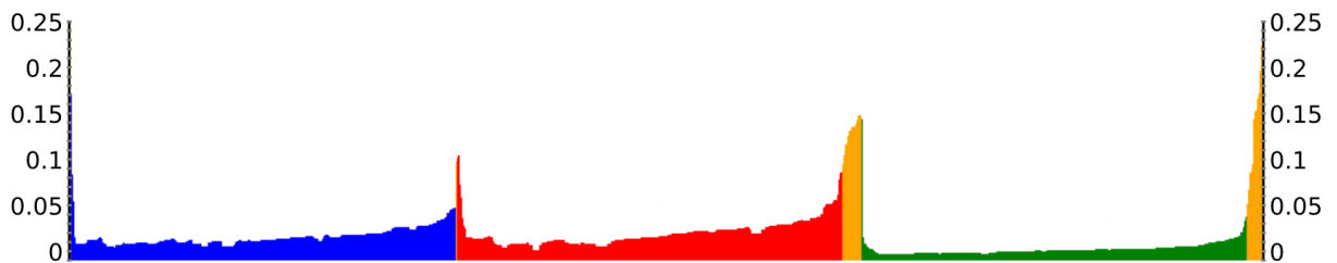
Рисунок 12. При кластеризации с помощью метода OPTICS точки линейно упорядочиваются таким образом, чтобы точки, лежащие близко в пространстве, были соседями. На графике по оси x отмечены точки в построенном порядке, по оси y отложено расстояние достижимости. Кластеры на графике выглядят, как «долины». Рисунок взят из [118].
