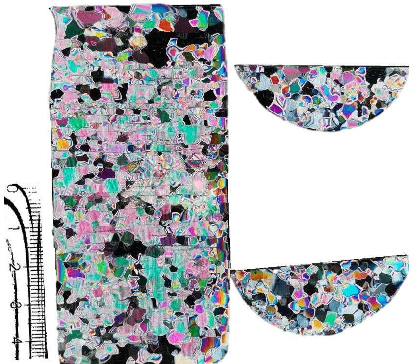
Рис. 124. Продольные и поперечные срезы образца № 1 б ультрапресного чистого льда в поляризованном свете без увеличения после длительного статического испытания методом трехосного сжатия
