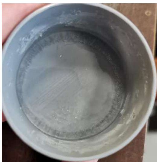
Рис. 44. Подбор толщины намораживаемого слоя при формировании искусственных образцов льда: а) при единоразовом добавлении менее 2 мл воды б) при единоразовом добавлении 2 мл воды (толщина слоя 1-3 мм)
