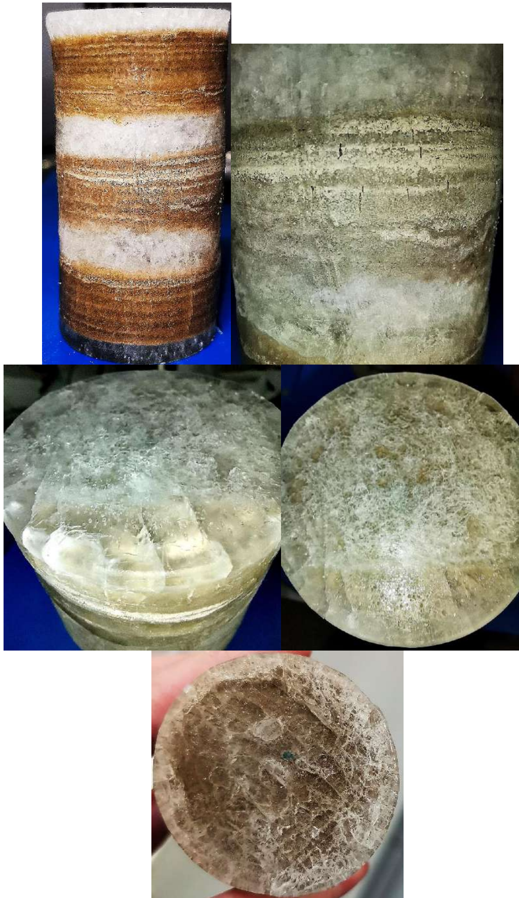
Рис. 82. Образец ледогрунта после испытания в условиях трехосного сжатия со скоростью деформирования 4 мм/мин при \sigma_3 = 0,3 МПа
