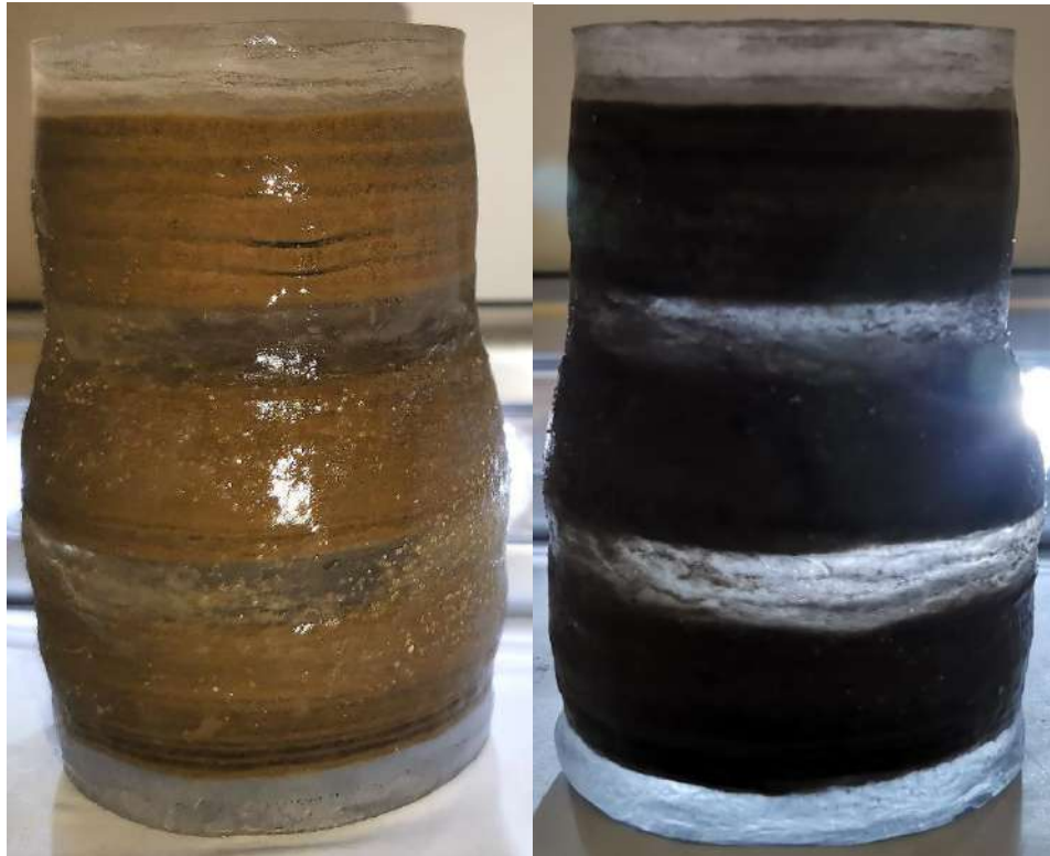
Рис. 97. Образец ледогрунта № 12 после длительного испытания в условиях трехосного сжатия при всестороннем давлении 0,5 МПа
