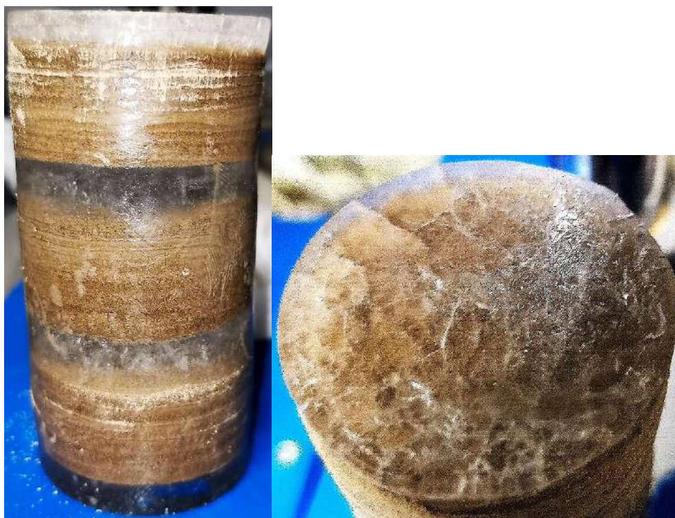
Рис. 83. Образец ледогрунта после испытания в условиях трехосного сжатия со скоростью деформирования 1 мм/мин при \sigma_3 = 0,4 МПа
