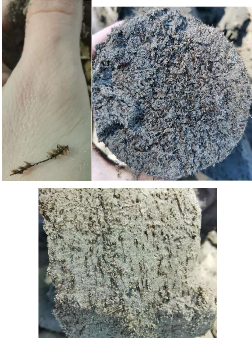
Рис. 6. Прослой неразложившегося органического вещества в песчаных грунтах казанцевской свиты в керне одной из скважин площадки строительства подземных резервуаров на территории Харасавэйского месторождения (фото автора)
