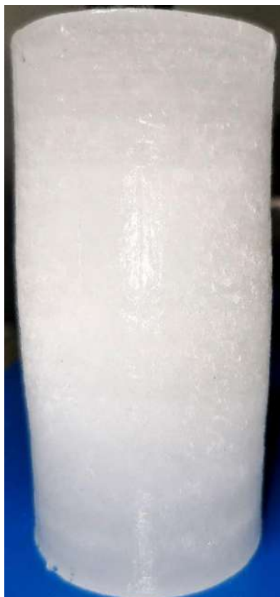
Рис. 85. Образец слабосоленого чистого льда после испытания в условиях трехосного сжатия со скоростью деформирования 4 мм/мин при \sigma_3 = 0,3 МПа
