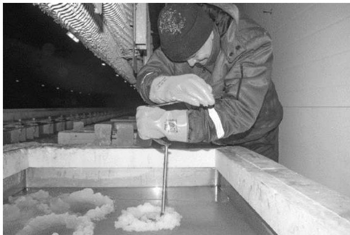
Рис. 41. Выбуривание образцов льда из искусственно сформированного массива льда [50]
