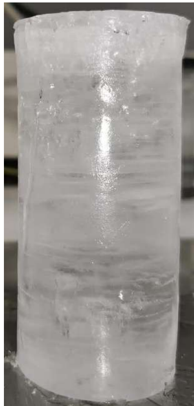
Рис. 80. Образцы ультрапресного чистого льда после испытаний в условиях трехосного сжатия при \sigma_3 = 0,3 МПа со скоростью деформирования:
