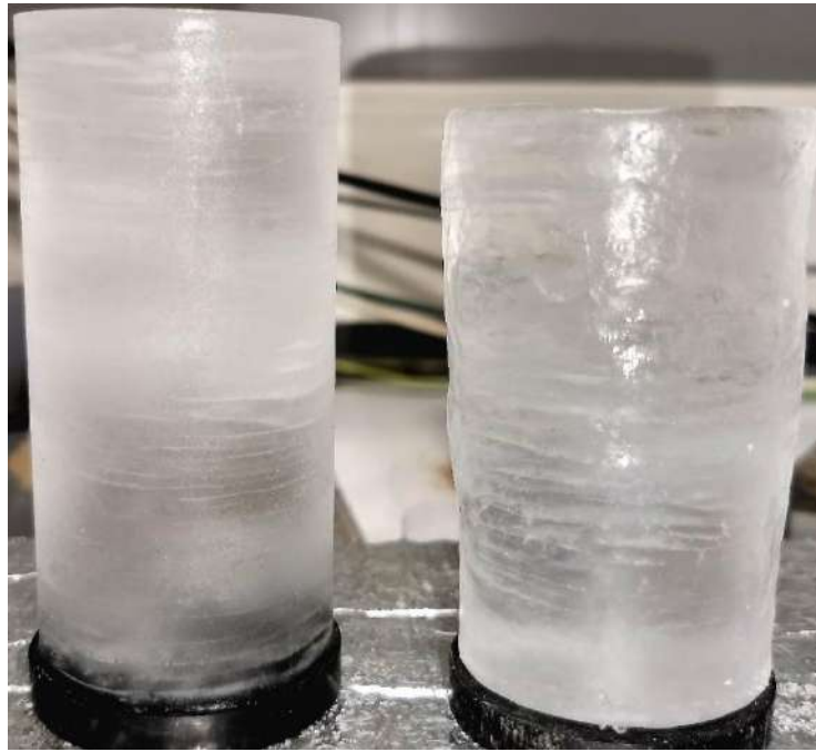
Рис. 90. Ультрапресный чистый лед до и после длительного испытания в условиях трехосного сжатия при всестороннем давлении 0,5 МПа
