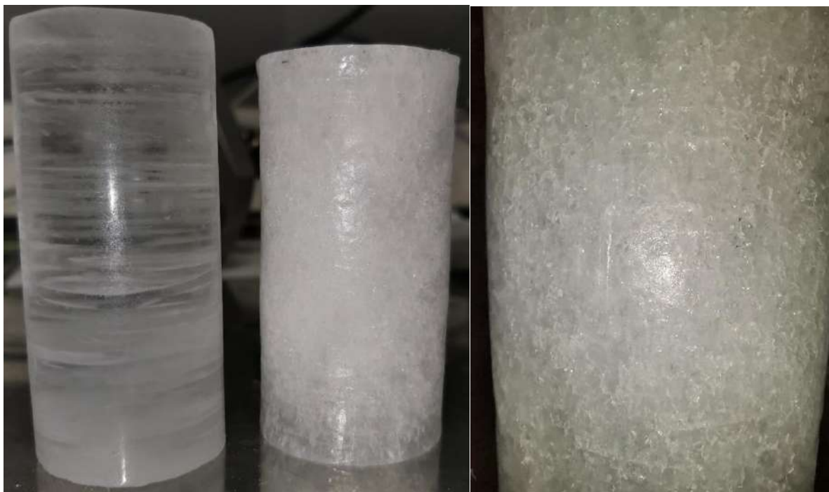
Рис. 78. Образец ультрапресного чистого льда до и после испытания в условиях трехосного сжатия со скоростью деформирования 4 мм/мин при \sigma_3 = 0,3 МПа
