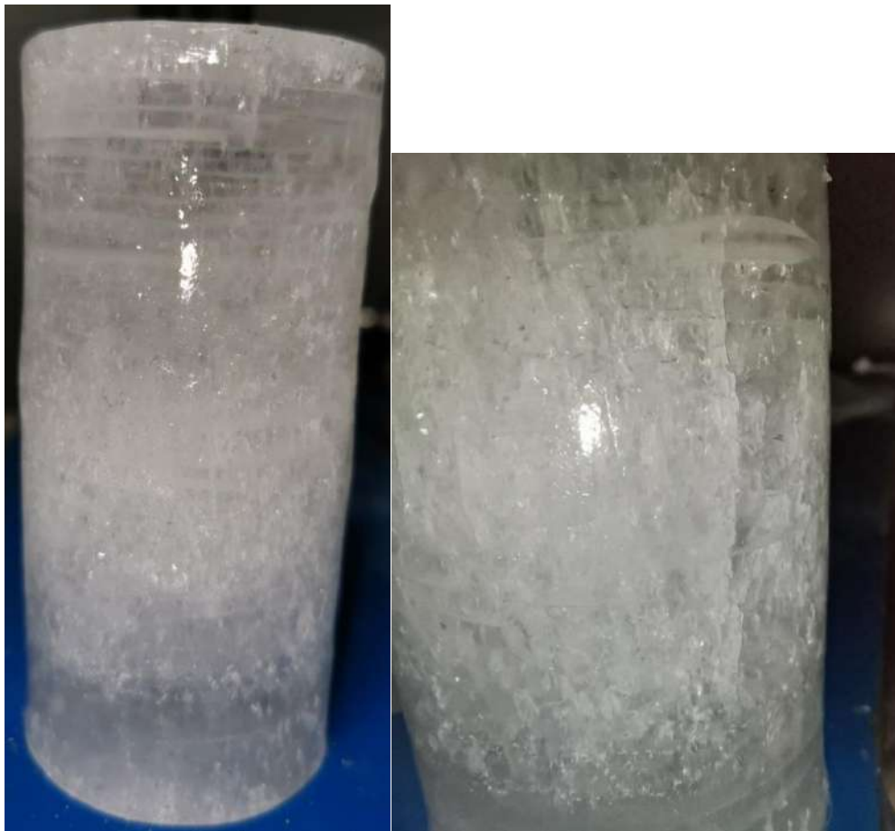
Рис. 79. Образец ультрапресного чистого льда после испытания в условиях трехосного сжатия со скоростью деформирования 1 мм/мин при \sigma_3 = 0,4 МПа
