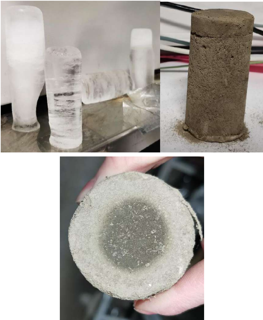
Рис.51. Сублимация льда и льда-цемента при длительном открытом хранении образцов
