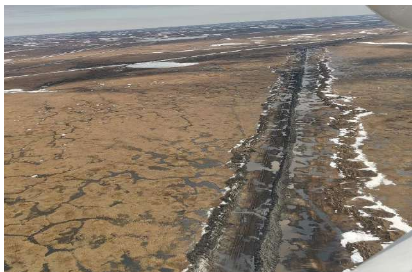
Рис. 24. Развитие процесса термокарста в результате техногенного нарушения почвенно-растительного покрова на территории Харасавэйского месторождения (фото автора)
