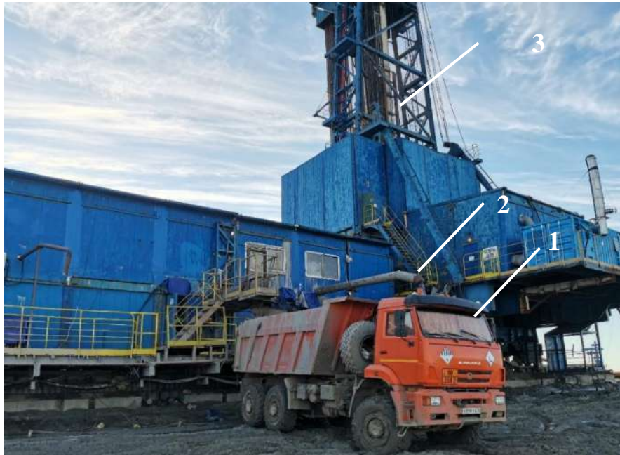
Рис. 133. Накопление отходов бурения на одной из кустовых газовых площадок территории Харасавэйского месторождения (фото автора): 1 – автотранспорт для накопления и транспортировки отходов бурения, 2 – подача отходов бурения от бурения эксплуатационной скважины, 3 – бурение эксплуатационной скважины
