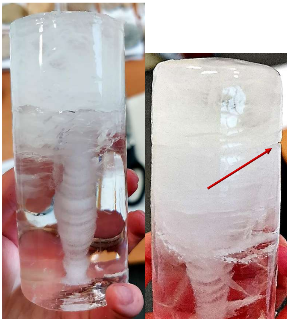
Рис. 40. Результаты изготовления ультрапресного чистого льда ошибочным методом
