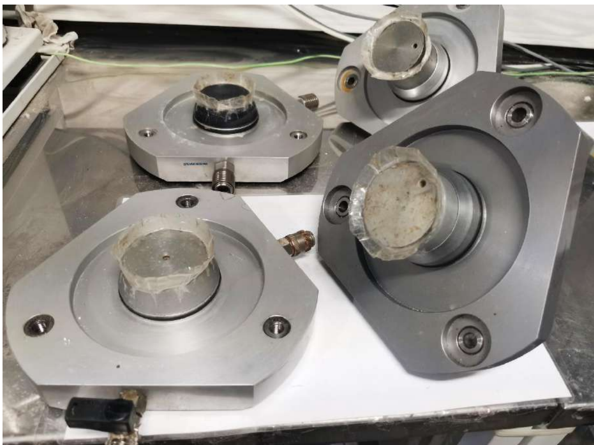
Рис. 53. Подготовленные пьедестал и верхний штамп для испытаний льда методом трехосного сжатия
