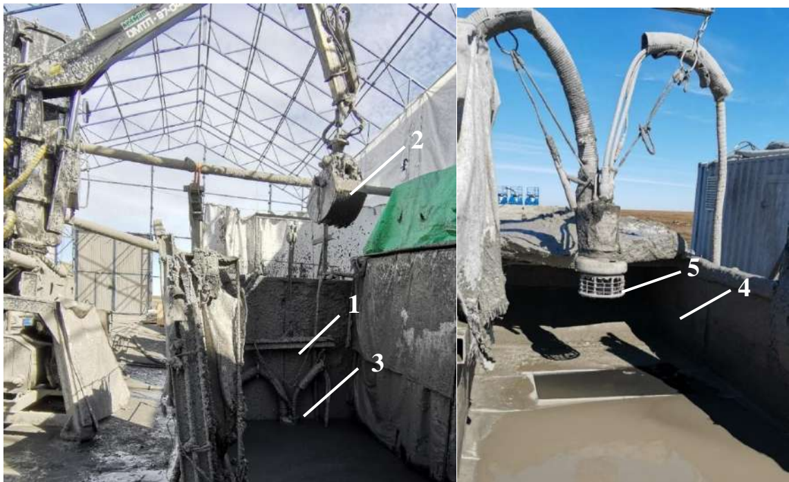
Рис. 133. Накопление отходов бурения на одной из кустовых газовых площадок территории Харасавэйского месторождения (фото автора): 1 – автотранспорт для накопления и транспортировки отходов бурения, 2 – подача отходов бурения от бурения эксплуатационной скважины, 3 – бурение эксплуатационной скважины
