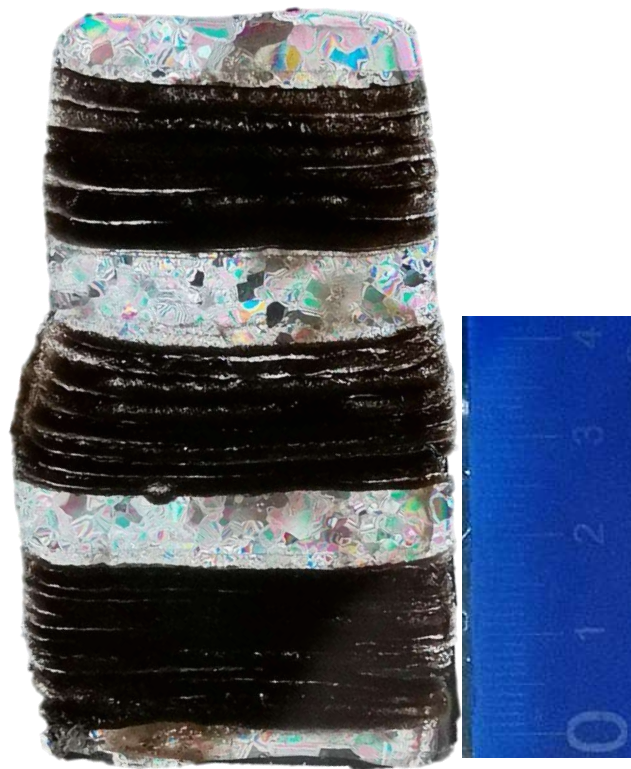
Рис. 127. Продольный срез образца № 12 ледогрунта в поляризованном свете без увеличения после длительного статического испытания в условиях трехосного сжатия
