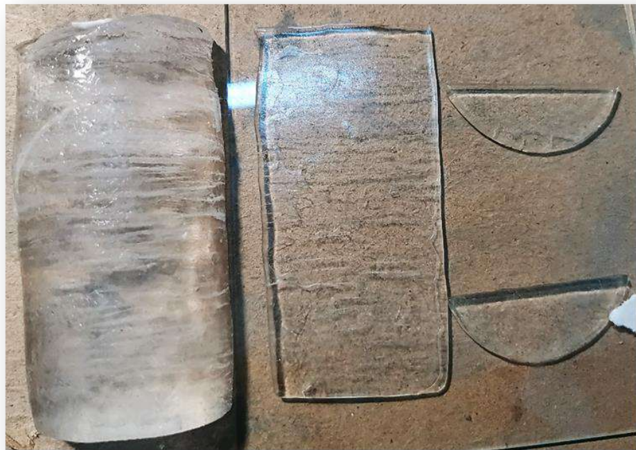
Рис. 111. Пример подготовки образцов для исследования структурно-текстурных особенностей льда
