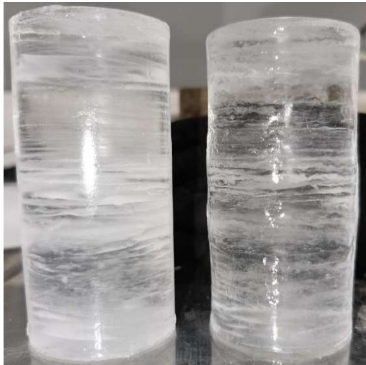
Рис. 92. Ультрапресный чистый лед до и после (образец № 15) длительного испытания в условиях трехосного сжатия при всестороннем давлении 0,1 МПа
