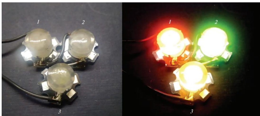
Рис. 15. Макеты излучателей, созданных с применением промышленных УФ-LED-источников и кристаллов: 1 - \text{La}_{0.58}\text{Eu}_{0.42}\text{MgB}_5\text{O}_{10} ; 2- \text{La}_{0.29}\text{Tb}_{0.71}\text{MgB}_5\text{O}_{10} ; 3 - \text{La}_{0.19}\text{Eu}_{0.04}\text{Tb}_{0.77}\text{MgB}_5\text{O}_{10} .
