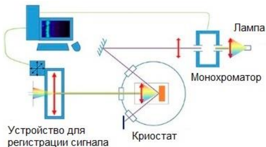
Рис. 2.7. Установка для измерения спектров ВФЛ.
