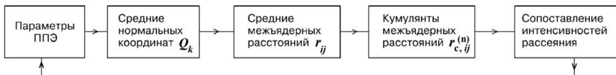
Рисунок 2.1 – Алгоритм решения обратной структурно-динамической задачи для жёстких молекул на основе данных ЭД с использованием программы ELDIFF
