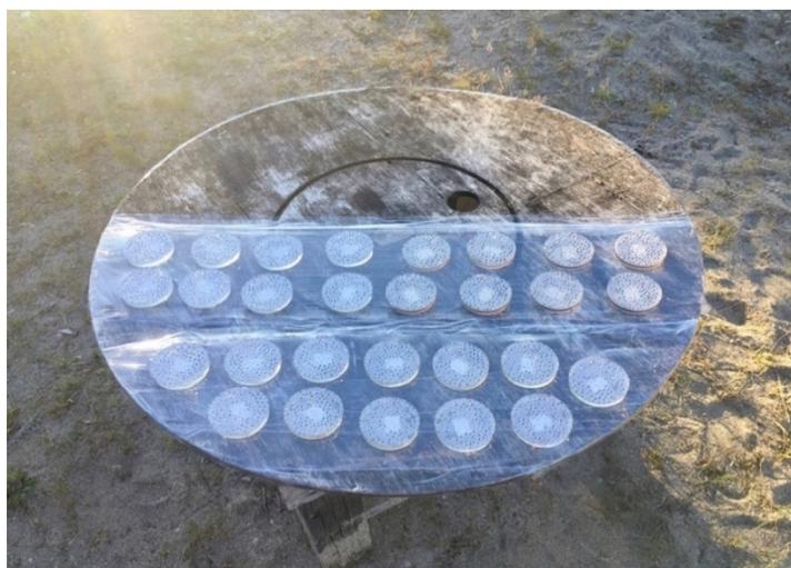
Рисунок 10. Постановка эксперимента по изучению трансформации органо-минеральных соединений водных объектов бореальной зоны под воздействием инсоляции
