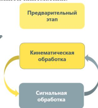
*Рисунок 8. Оптимальная последовательность процедур обработки сейсмических данных в осложненных условиях Восточной Сибири*
