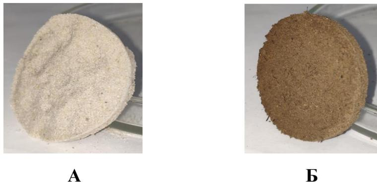
**Рисунок 43.** Фотографии композитных корок на основе микрогеля АМГ# и песка (**А**), а также микрогеля АМГ# и почвы (**Б**).
