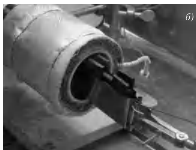
Рисунок 2.1-11. а – графитовая оболочка с крышкой (сверху); б – плавка Sb в процессе заполнения оболочки.
