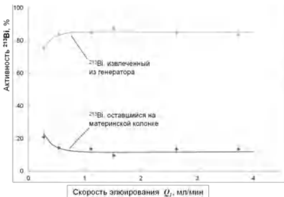
Рисунок 3-49. Зависимость эффективности извлечения ^{213}\text{Bi} от скорости Q_1 циркуляции раствора 0.25 М \text{HNO}_3 (скорости элюирования). Объем раствора для распада ^{221}\text{Fr} 10 мл. Скорость финишного прокачивания раствора через ^{213}\text{Bi} колонку во флакон Q_2 = 5 мл/мин.
