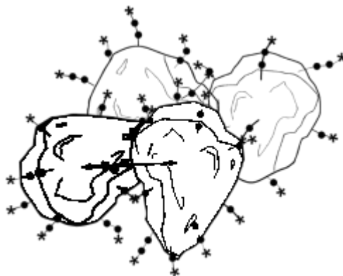
Рисунок 3-60. Схема сорбции висмута на гранулах сорбента в хроматографической колонке ( l_c – среднее расстояние между гранулами сорбента в колонке).
