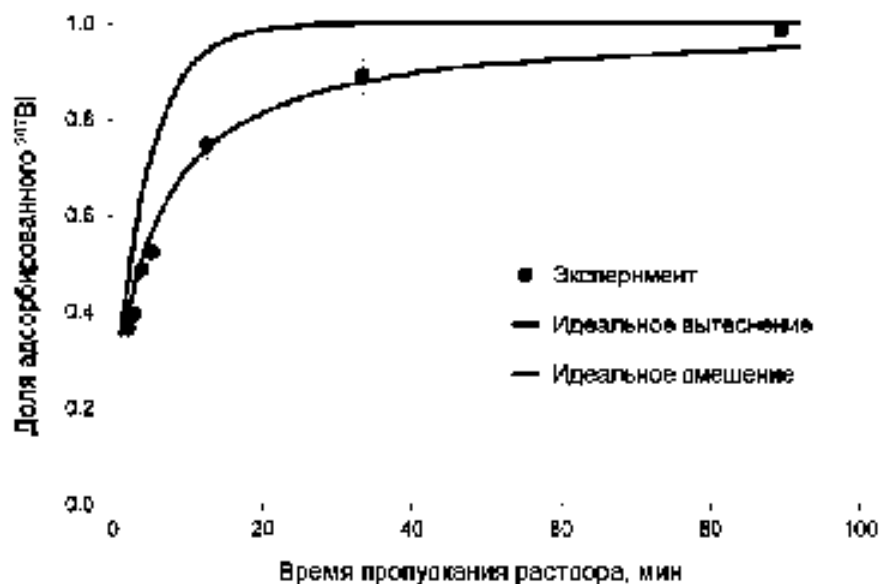
Рисунок 3-65. Доля ^{207}\text{Bi} , адсорбированного в колонке, заполненной сорбентом Т-39, в зависимости от времени пропускания раствора 0.1 М \text{HNO}_3 , содержащего ^{207}\text{Bi} . Масса сорбента 100 мг, объем пропущенного раствора 5 мл. Синяя кривая рассчитана по уравнению (3-37), красная кривая – по уравнению (3-42).
