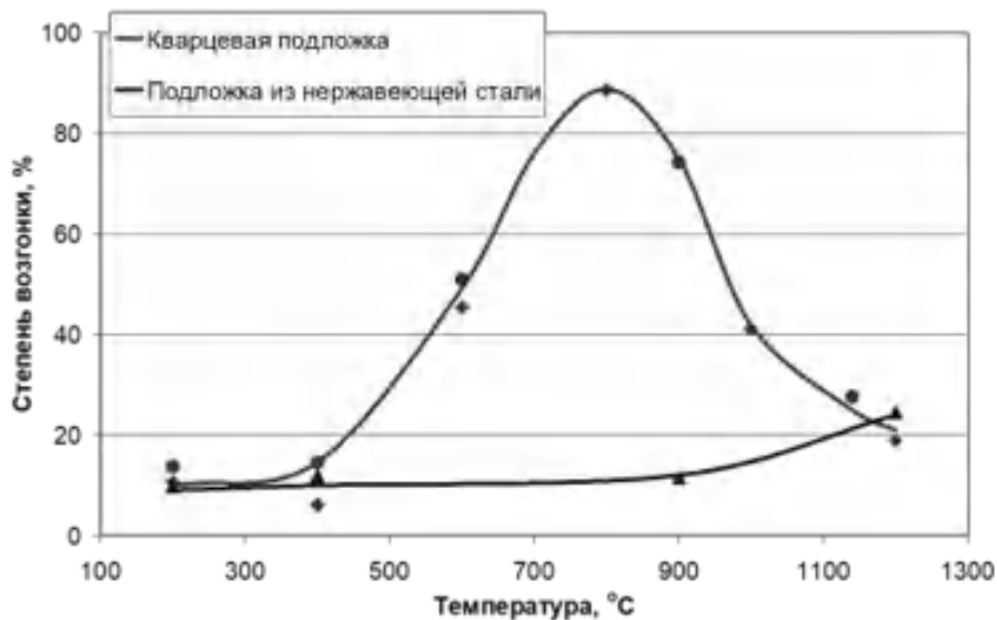
Рисунок 3-24. Зависимость степени возгонки изотопов радона ^{219,220}\text{Rn} с поверхности подложки, содержащей материнские радионуклиды ^{223,224}\text{Ra} , от температуры нагрева. Время нагрева ~ 4 часа, расход аргона 50 мл/мин.
