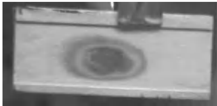
Рисунок 2.1-12. а – сборка из трех Sb мишеней в графитовой оболочке и держатель для них; б – выходное окно третьей облученной мишени (по ходу пучка, общий заряд 2500 \mu\text{A}\cdot\text{ч} ).
