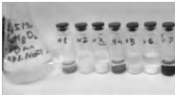
Рисунок 3-17. Сорбенты после контакта с раствором 0.3 М аскорбиновой кислоты:
