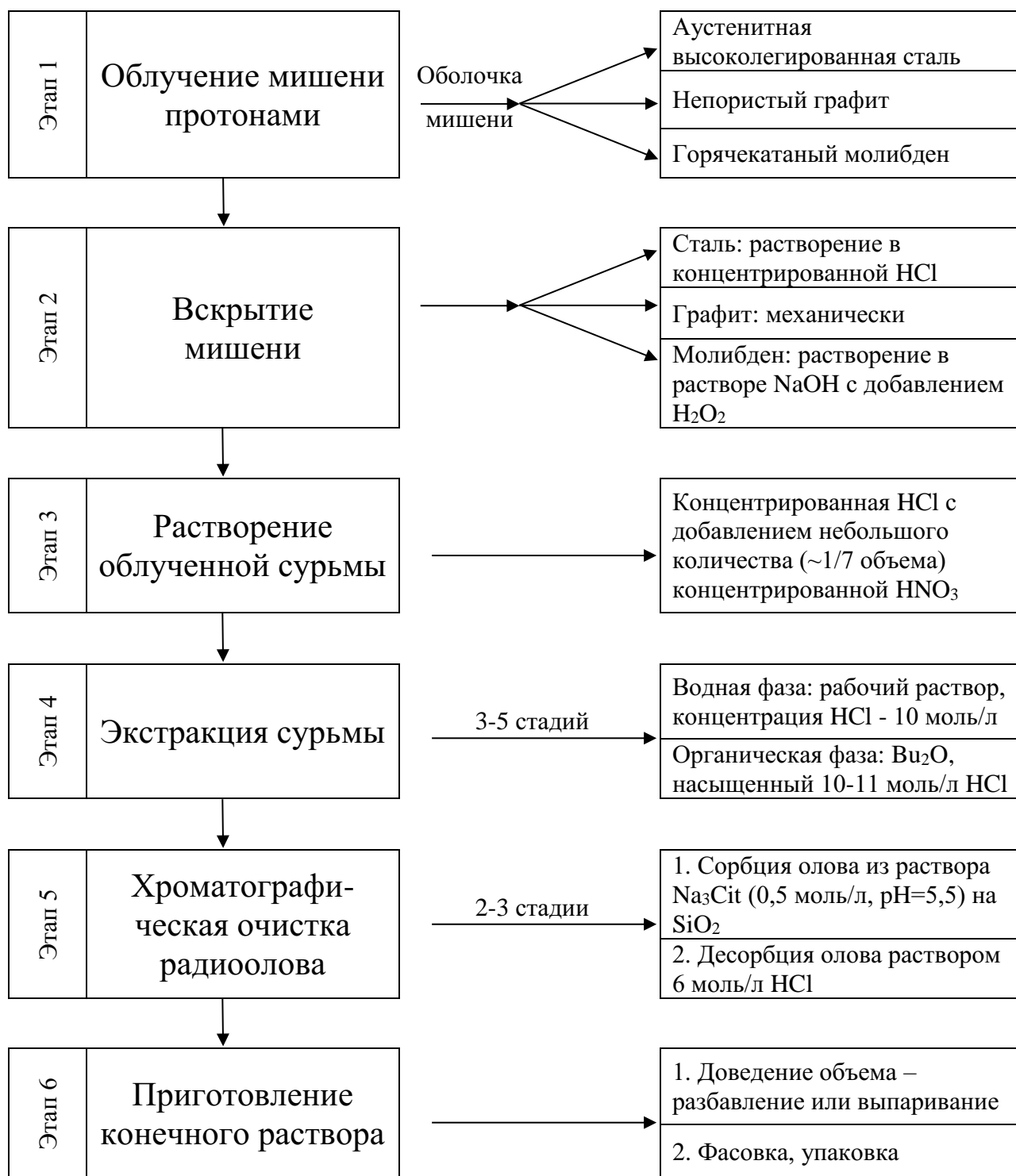
Рисунок 2.1-18. Схема переработки облученной сурьмяной мишени и выделения 117m Sn в состоянии без носителя.
