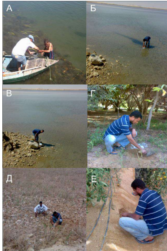
Рисунок 3-3: Рисунок показывает пробоотбор поверхностных отложений и почвы вдоль двух берегов египетского Нила (А, Б и В донные отложения) и (Г, Д и Е почвы)
