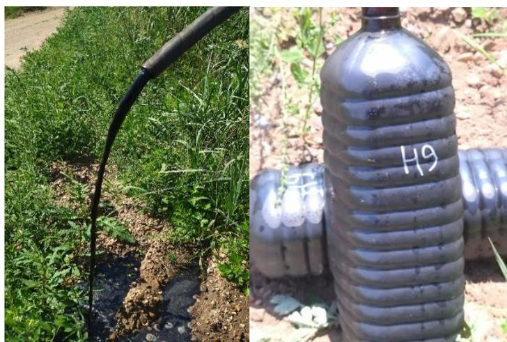
**Рисунок 47.** Фотографии воды из скважины ЧМ- Н9 на изливе (справа) и в бутылке через год после нагнетания органической смеси.
