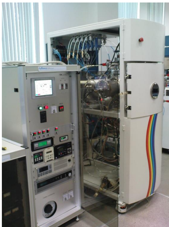
Рис. 8. Фотография высоковакуумной камеры и блока управления установки, которая использовалась для изготовления исследуемых покрытий.
