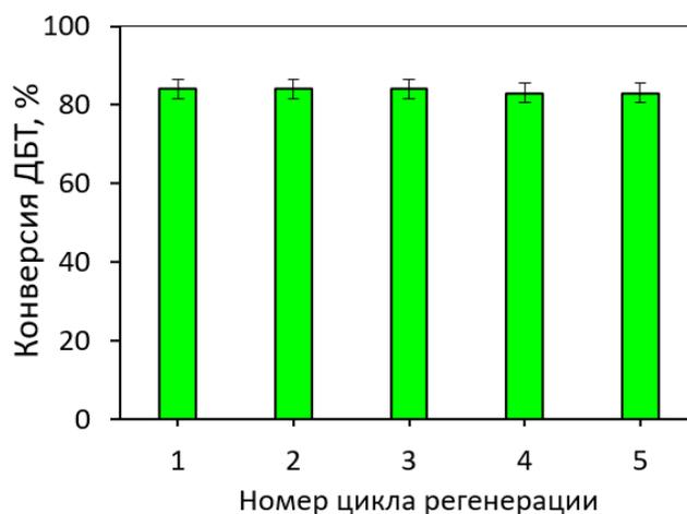
Рисунок 3.69. Повторное использование катализатора после регенерации. Условия окисления:  $\text{H}_2\text{O}_2 : \text{S} = 6:1$  (мольное), 9 мг PAF-30-SO<sub>3</sub>H (10,0)/5 мл модельной смеси, 70 °С, 60 мин
