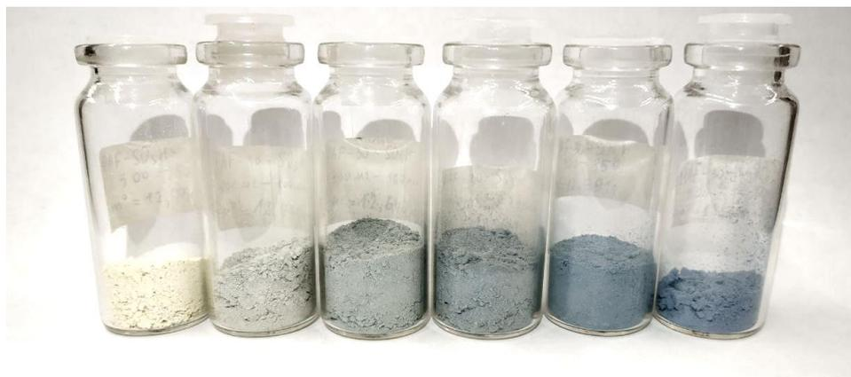
Рисунок 3.61. Катализаторы на основе PAF-30 (слева направо): PAF-30-SO<sub>3</sub>H (1) (желтый); PAF-30-SO<sub>3</sub>H (2,5) (светло-зеленый); PAF-30-SO<sub>3</sub>H (5) (зеленый); PAF-30-SO<sub>3</sub>H (7,5) (темно-зеленый); PAF-30-SO<sub>3</sub>H (10) (синий); PAF-30-SO<sub>3</sub>H (12,5) (синий)
