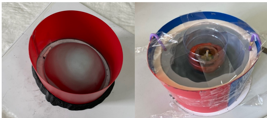
Рис. 1.8 Фотографии подготовленных к заливке силикона форм нижней части (слева) и верхней части (справа). На фотографии справа фиолетовые стержни по краям – шаблоны вентиляционных каналов, конус посередине – шаблон литника.
