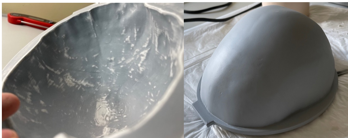
Рис. 1.6 Фотографии промежуточного этапа процесса заполнения дефектов шпаклевкой и грунтовкой с последующей шлифовкой (слева) и готовой сглаженной мастер-модели для отливки силиконовой формы.
