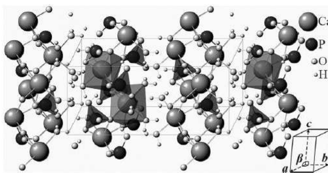
Рис. 2.28. Структура элементарной ячейки брушита [100]
