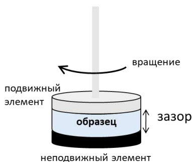
Рис. 3.4. Схема измерительной ячейки с образцом гидрогеля.
