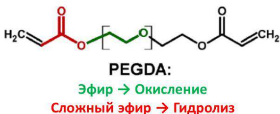
Рис. 2.16. Эфирный фрагмент ПЭГ-ДА восприимчив к окислению, а концевые группы гидролитически лабильны [52].
