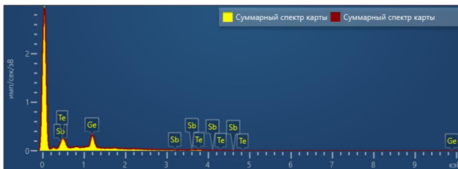
Рисунок 3.14. ЭДРС-спектр для образца D4 с указанием весовых и атомных концентраций элементов.
