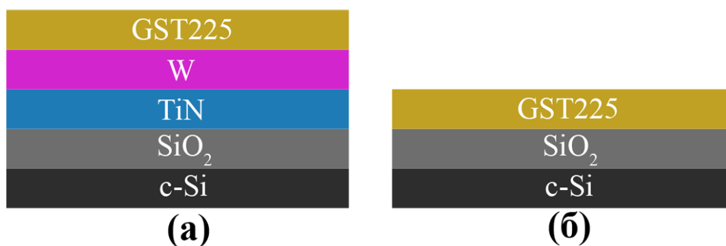
Рисунок 2.1. Схематические изображения исходных образцов аморфных тонких пленок GST225, осажденных на проводящие \text{W}/\text{TiN}/\text{SiO}_2/\text{c-Si} (а) и диэлектрические подложки \text{SiO}_2/\text{c-Si} (б).
