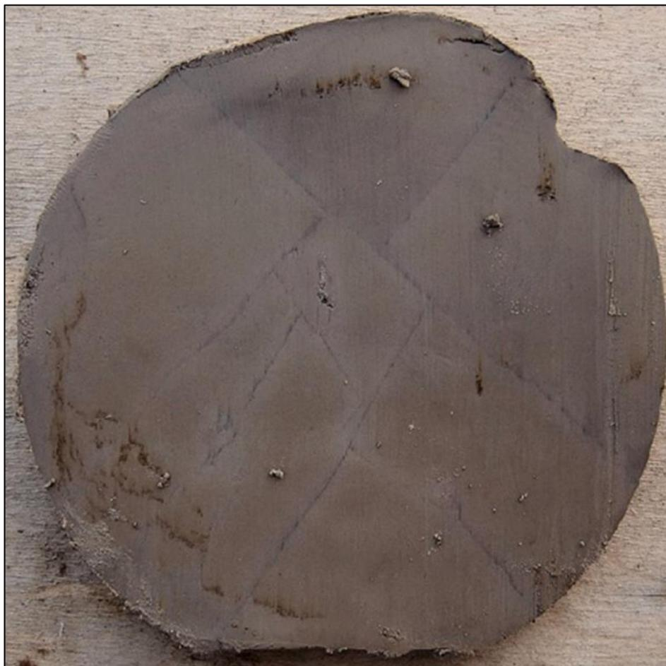
Рис. 22. Скважина R1, 26.9 м. Трещины усыхания в отложениях ательского горизонта (фото В.М. Сорокина).
