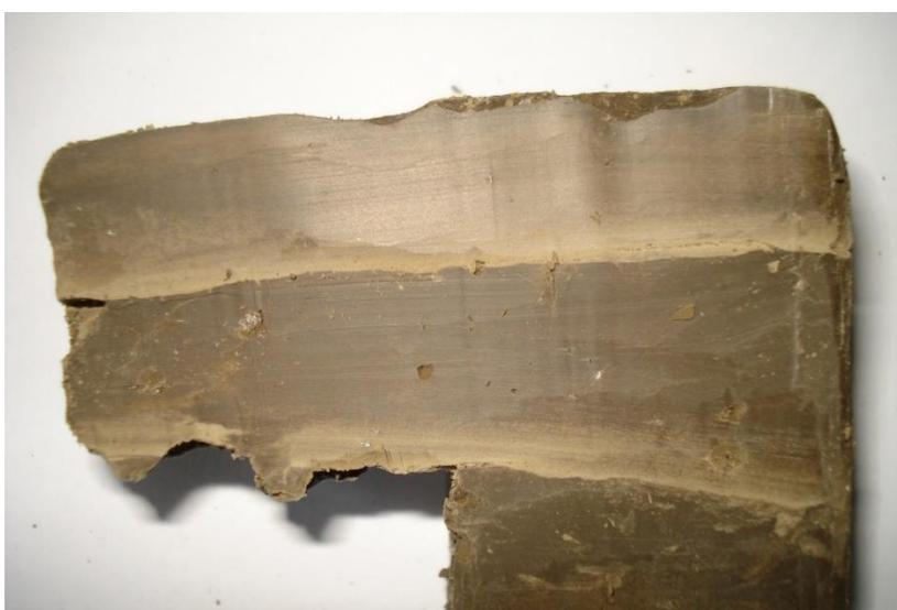
Рис. 29. Скважина КНВ5, 14,8 м. Чередование коричневых глин со светлым алевритистым материалом.
