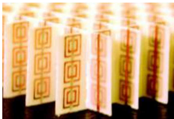
Рисунок 3.1. Фотография метаматериала, состоящего из массива разомкнутых кольцевых резонаторов и металлических полосок [8]. Период структуры в латеральном направлении – 5 мм.
