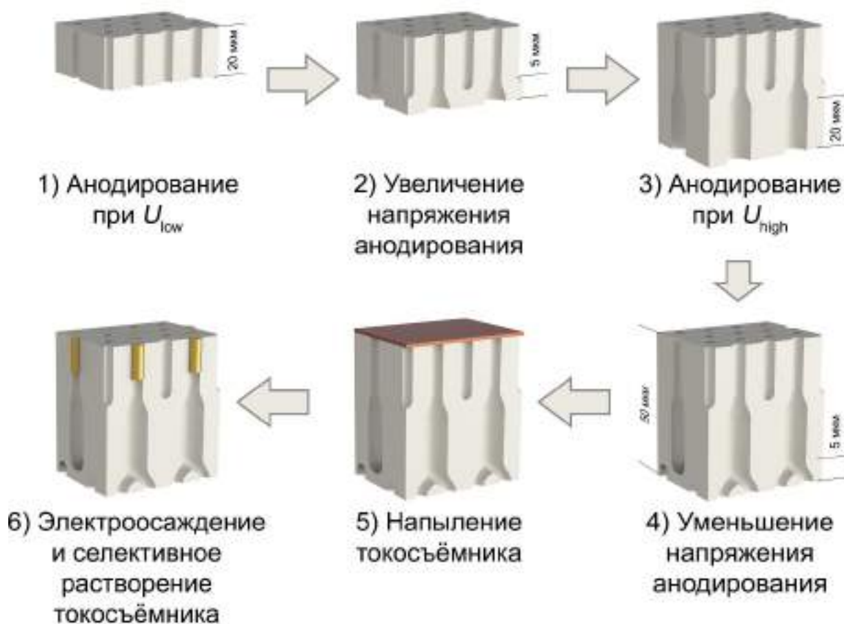
Рисунок 5.1. Схема получения металл-оксидных наноконпозитов на основе плёнок анодного оксида алюминия с частично заблокированными каналами.
