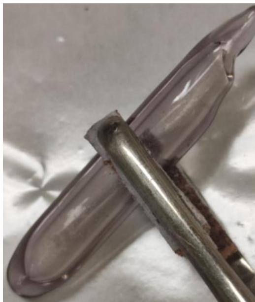
Рисунок 2-19 – Ампула с оксидом гадолиния после облучения в реакторе
