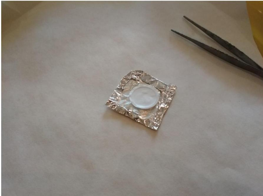
Рисунок 2-2 – Препарат для альфа-спектрометрии, полученный микроосаждением на фильтре
