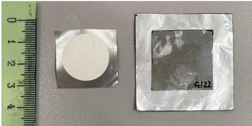
Рисунок 2-8 – Мишень  $^{\text{nat}}\text{Gd}_2\text{O}_3$  толщиной  $10 \text{ мг}/\text{см}^2$ , нанесенная на алюминиевую подложку толщиной 20 мкм без покрытия (слева) и с покрытием из алюминиевой фольги толщиной 8,3 мкм (справа)
