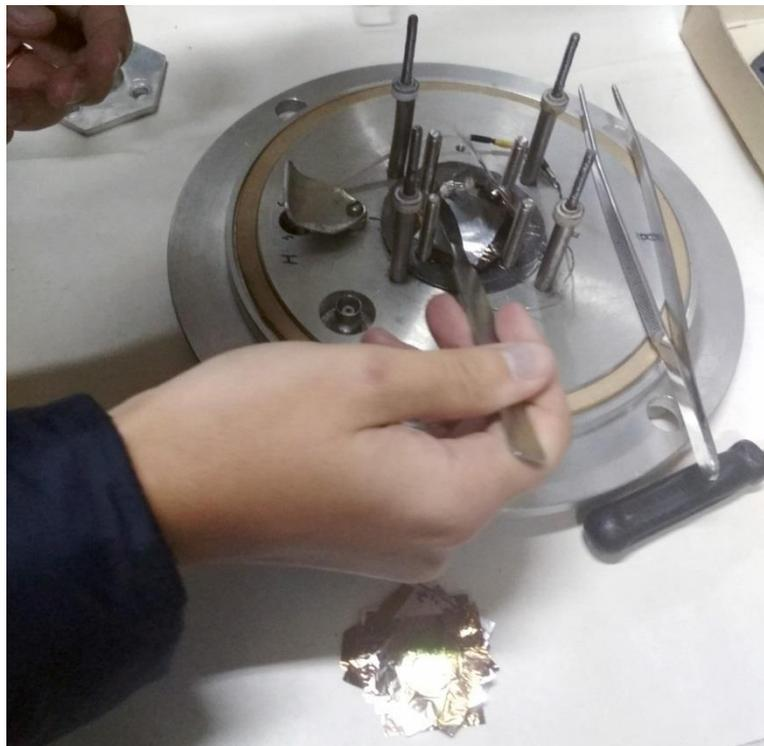
Рисунок 2-12 – Стопка фольг в мишенном устройстве в процессе демонтажа
