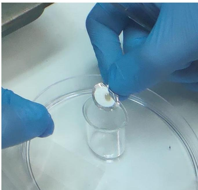
Рисунок 2-22 – Процесс вскрытия мишени после облучения. Темное пятно на белом слое оксида европия-151 – след от пучка циклотрона
