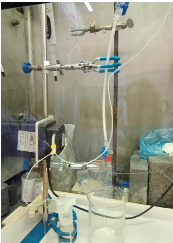
Рисунок 2-25 – Хроматографическая колонка, подключенная к перистальтическому насосу
