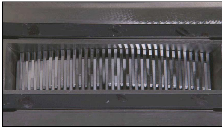
Рисунок 2.2 – Многолепестковый коллиматор TomoTherapy
