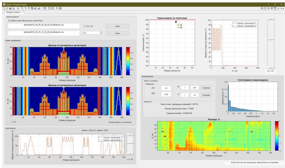
Рисунок 4.7 – Анализ созданной вручную синограммы
