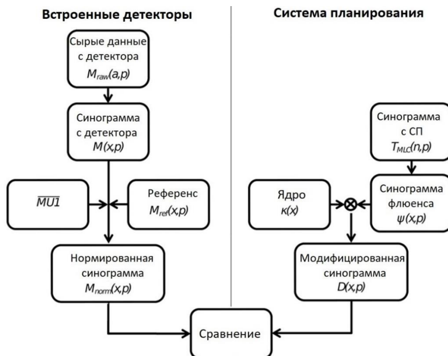
Рисунок 1.6 – Схема работы с данными со встроенных детекторов
