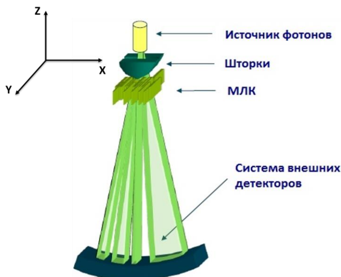
Рисунок 2.1 – Схема доставки дозы в аппарате TomoTherapy
