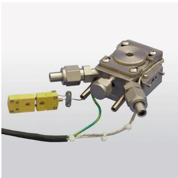
**Рисунок 39.** Ячейка Harrick HVC-MRA-5 для метода спектроскопии КР *in situ*
